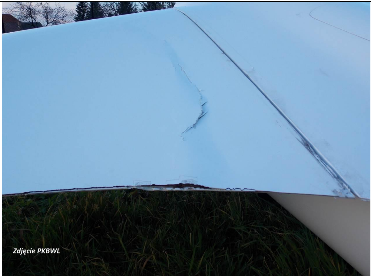
Ilustracja nr 1. Uszkodzone pokrycie górne skrzydła, widoczne rozwarstwienie laminatu na krawędź spływu .
