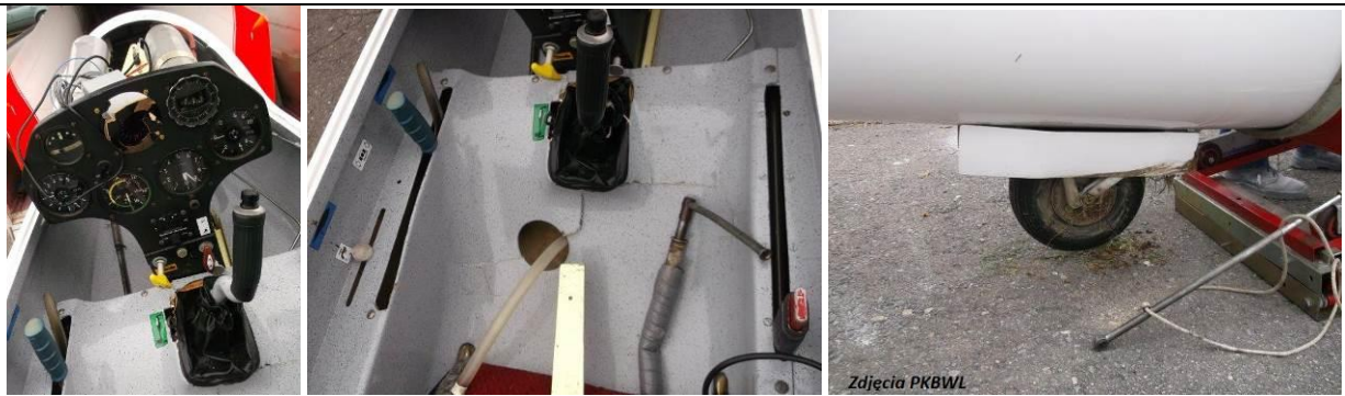
Ilustracja nr 3. Uszkodzenia w obrębie kabiny oraz uszkodzona osłona podwozia.
