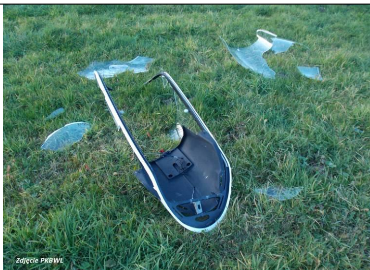
Ilustracja nr 2. Uszkodzenia owiewki kabiny.
