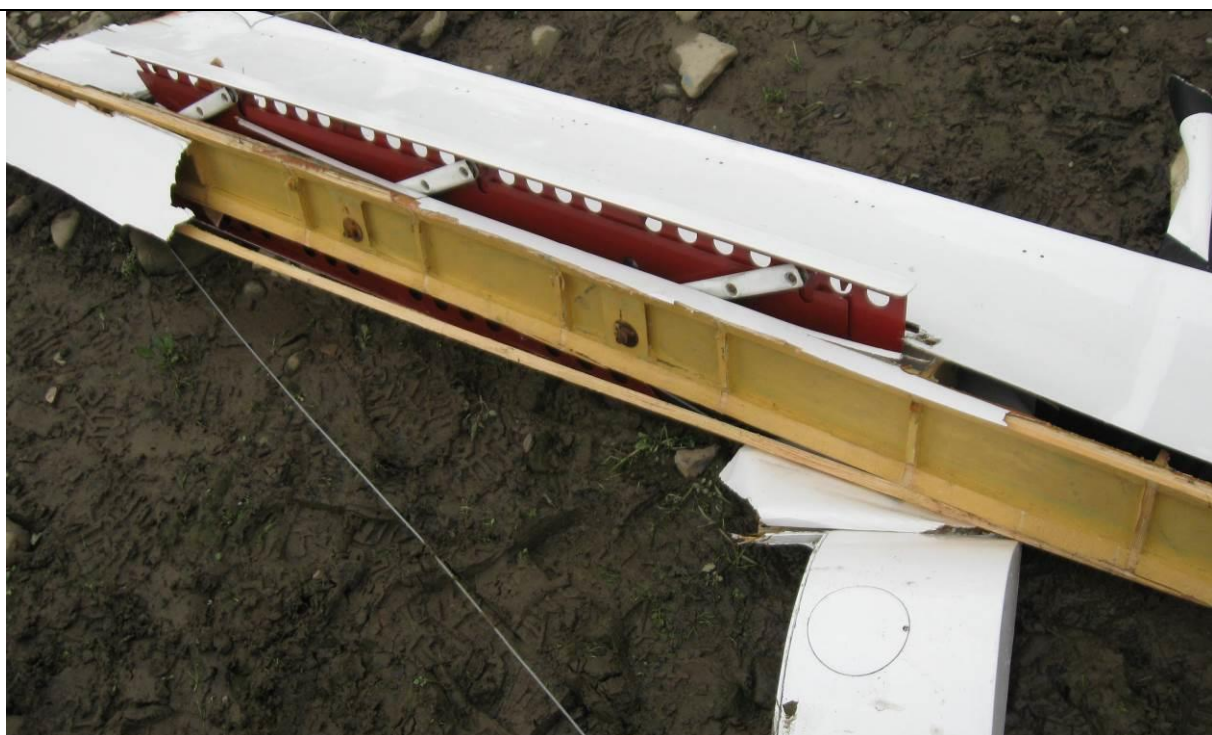
1 Ilustracja nr 4. Uszkodzenia prawej części centroplata w okolicy skrzynki hamulcowej.
