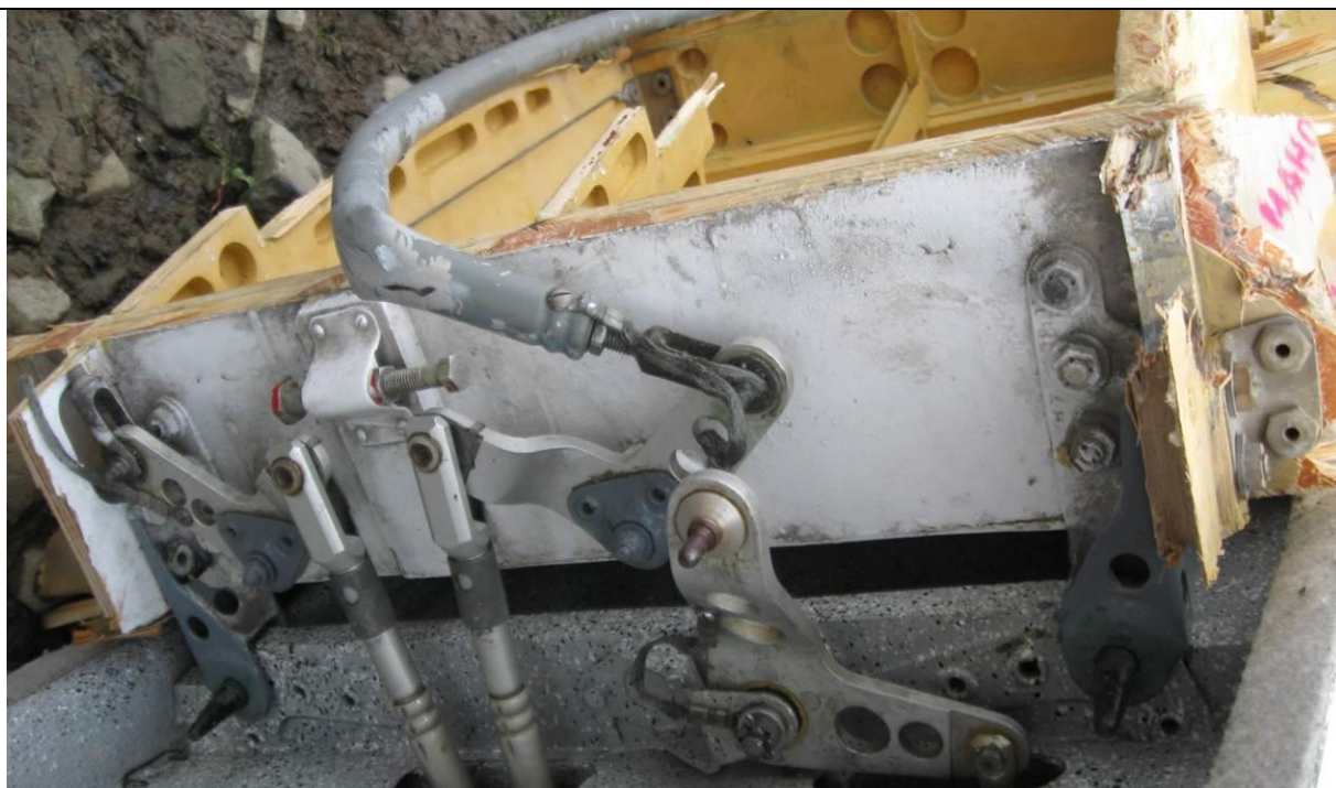
1 Ilustracja nr 3. Uszkodzony centropląt, widok na podłączenia napędów lotek i hamulców aerodynamicznych
