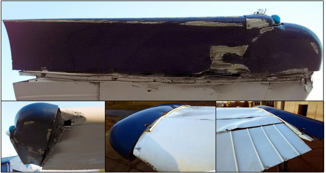
5, 6, 7, 8 – Ogólny widok uszkodzeń końcówki prawego skrzydła i górnego pokrycia prawego skrzydła przy końcówce. [fot.FEAC sp. z o.o.]
