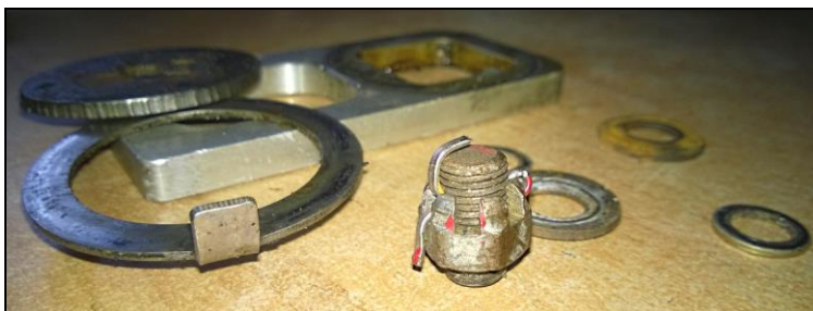
6 – Wszystkie części złączne mocowania widelca do osi obrotu na goleni podwozia przedniego, odnaleziony na drodze startowej oraz odłamany gwintowany fragment szpilki goleni podwozia wraz z nakrętką i zawleczką zabezpieczającą [foto: Aeroklub Warmińsko-Mazurski].
