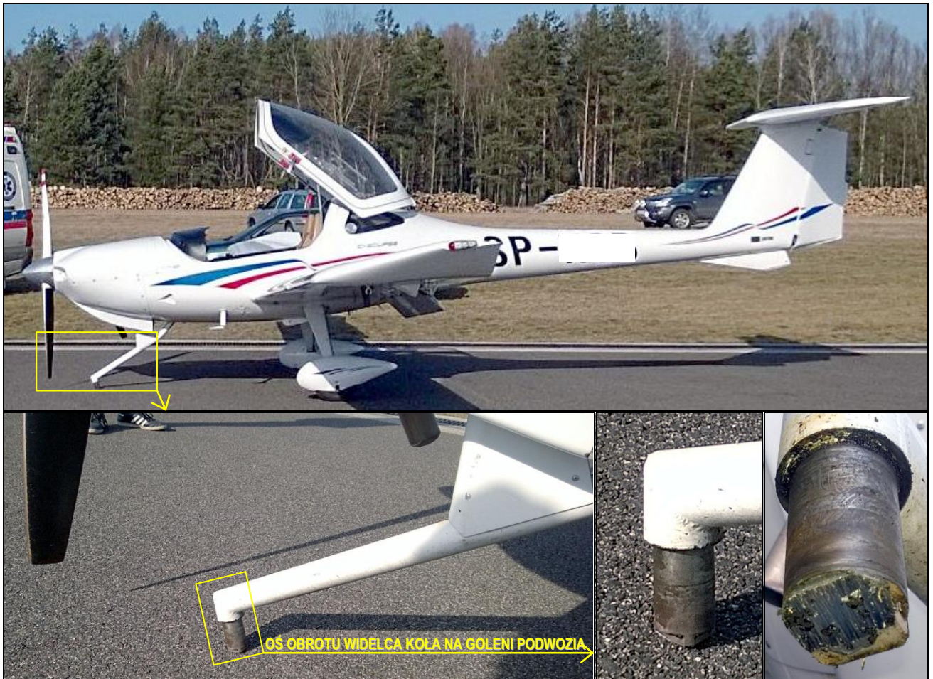
1, 2, 3, 4 – Zdjęcia ilustrujące uszkodzenie podwozia przedniego po lądowaniu [foto: Aeroklub Warmińsko-Mazurski].
