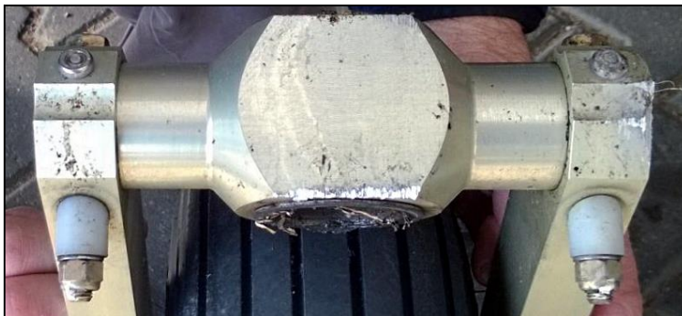
5 – Powyżej: przegub mocowania widelca z kołem do osi obrotu na goleni podwozia przedniego, odnaleziony na drodze startowej [foto: Aeroklub Warmińsko-Mazurski].
