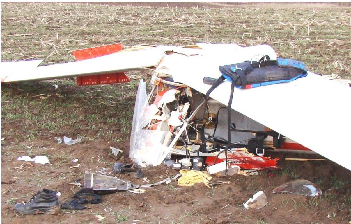
Ilustracja nr 3. Rozbita kabina szybowca.
