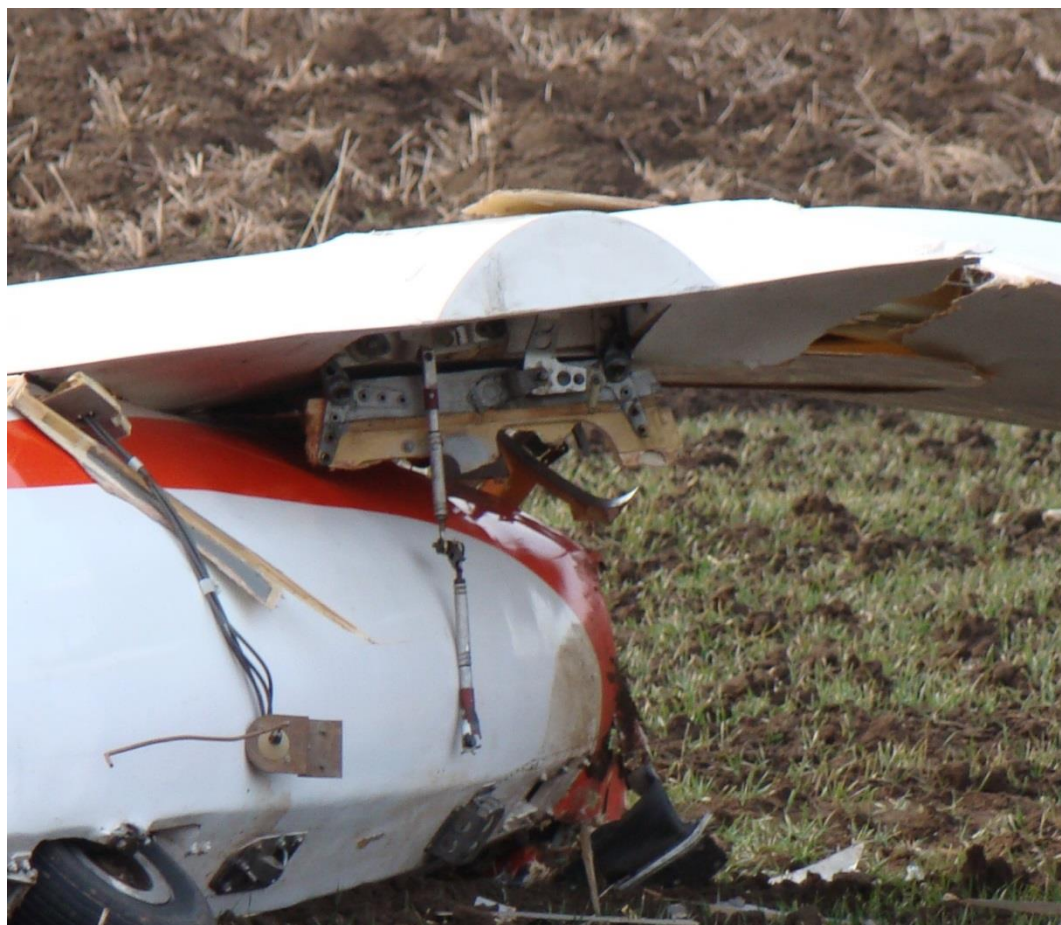
Ilustracja nr 4. Skrzynka mocowania okuć. Widoczne podłączone napędy sterów.
