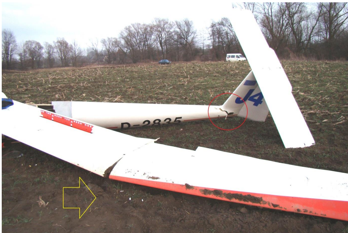
Ilustracja nr 5. Ślad uderzenia lewego skrzydła o ziemię. Widoczne uszkodzenie belki ogonowej w rejonie statecznika pionowego.
