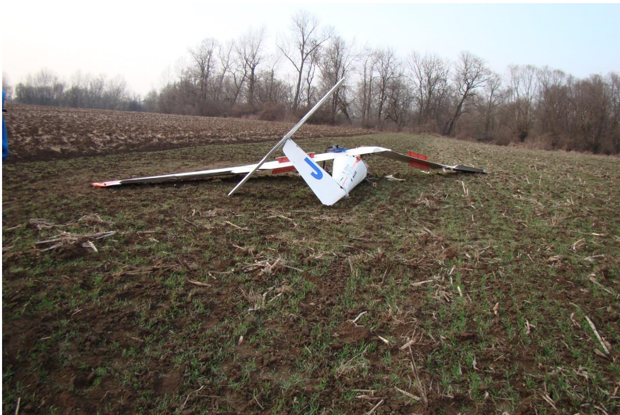
Ilustracja nr 1. Widok na rozbity szybowiec - brak śladów dobiegu szybowca.
