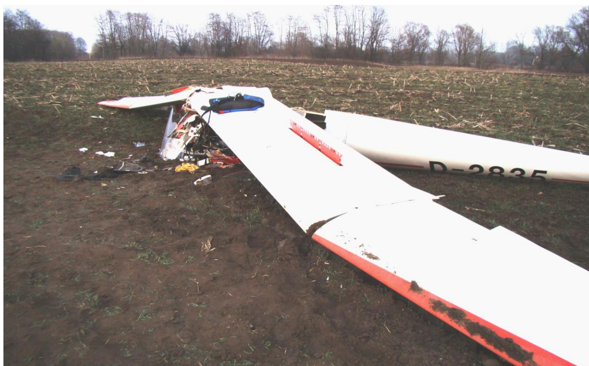
Ilustracja nr 2. Stan szybowca po wypadku. Widoczna całkowicie rozbita przednia część kadłuba.
