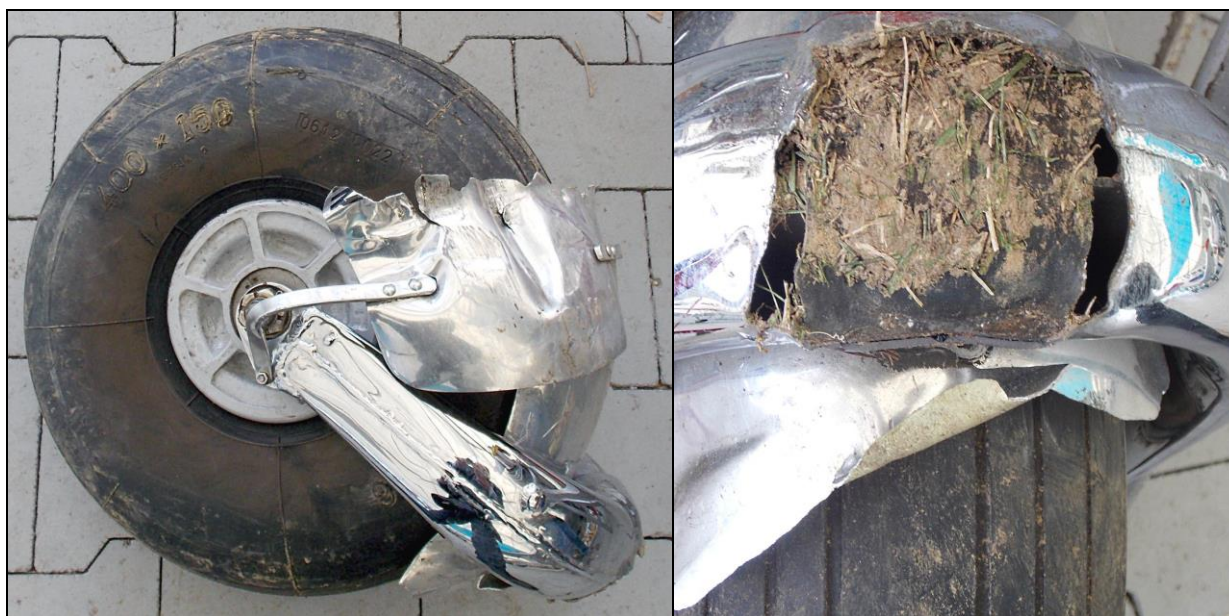
21, 22 – Odlamany od osi skrętu widelec przedniego podwozia z kołem i zbliżenie na zniszczoną spoinę łączącą widelec z osią skrętu.
