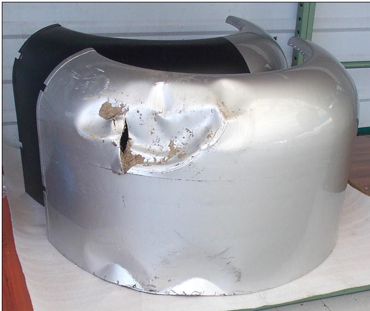
20 – Zdemontowane osłony silnika – widoczne uszkodzenia dolnej osłony.
