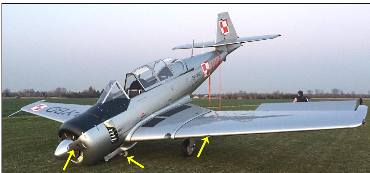
18 – Samolot na miejscu zatrzymania. Widoczne uszkodzenia: zniszczone śmigło, uszkodzone podwozie przednie, wgniecenie na nosku lewego skrzydła po uderzeniu widelcem przedniego podwozia [fot. Użytkownik samolotu].
