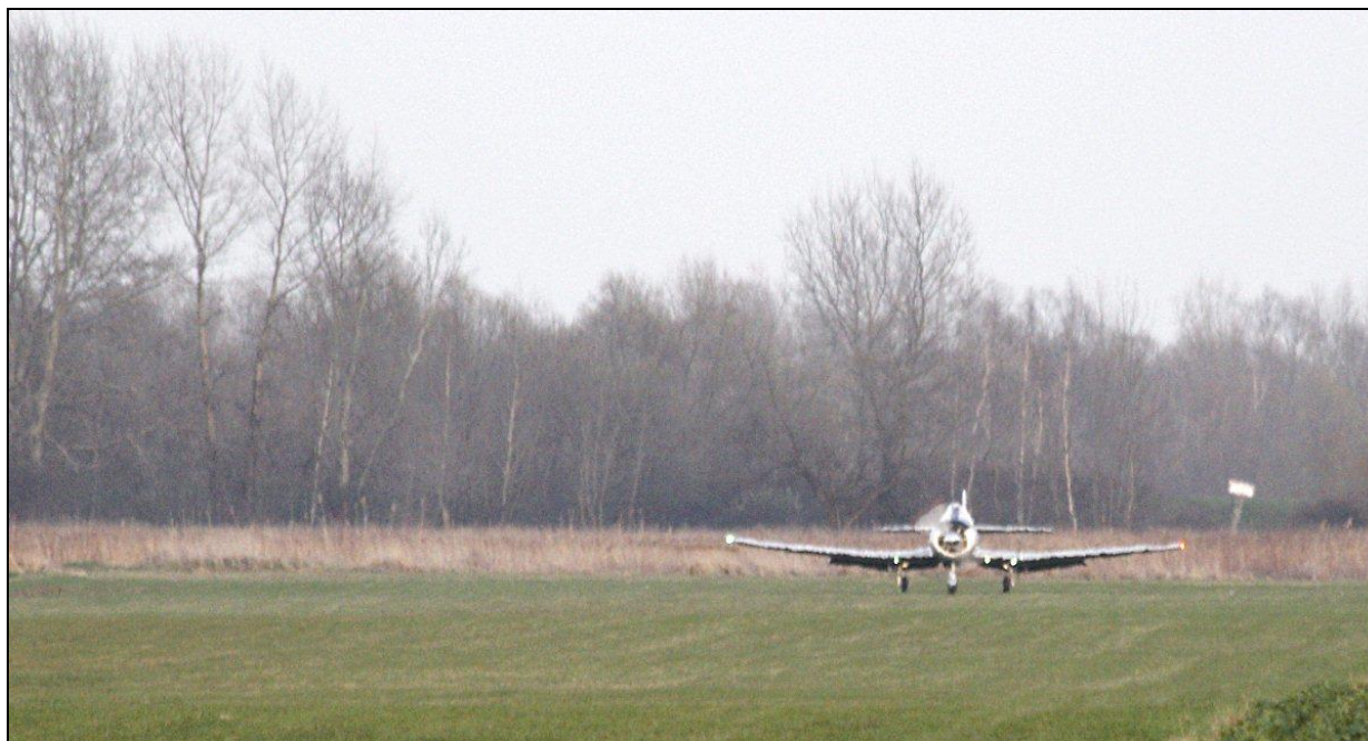
7 – Przyziemienie na trzy koła – punkt A na ilustracji 4 [fot. Piotr Gliga].
