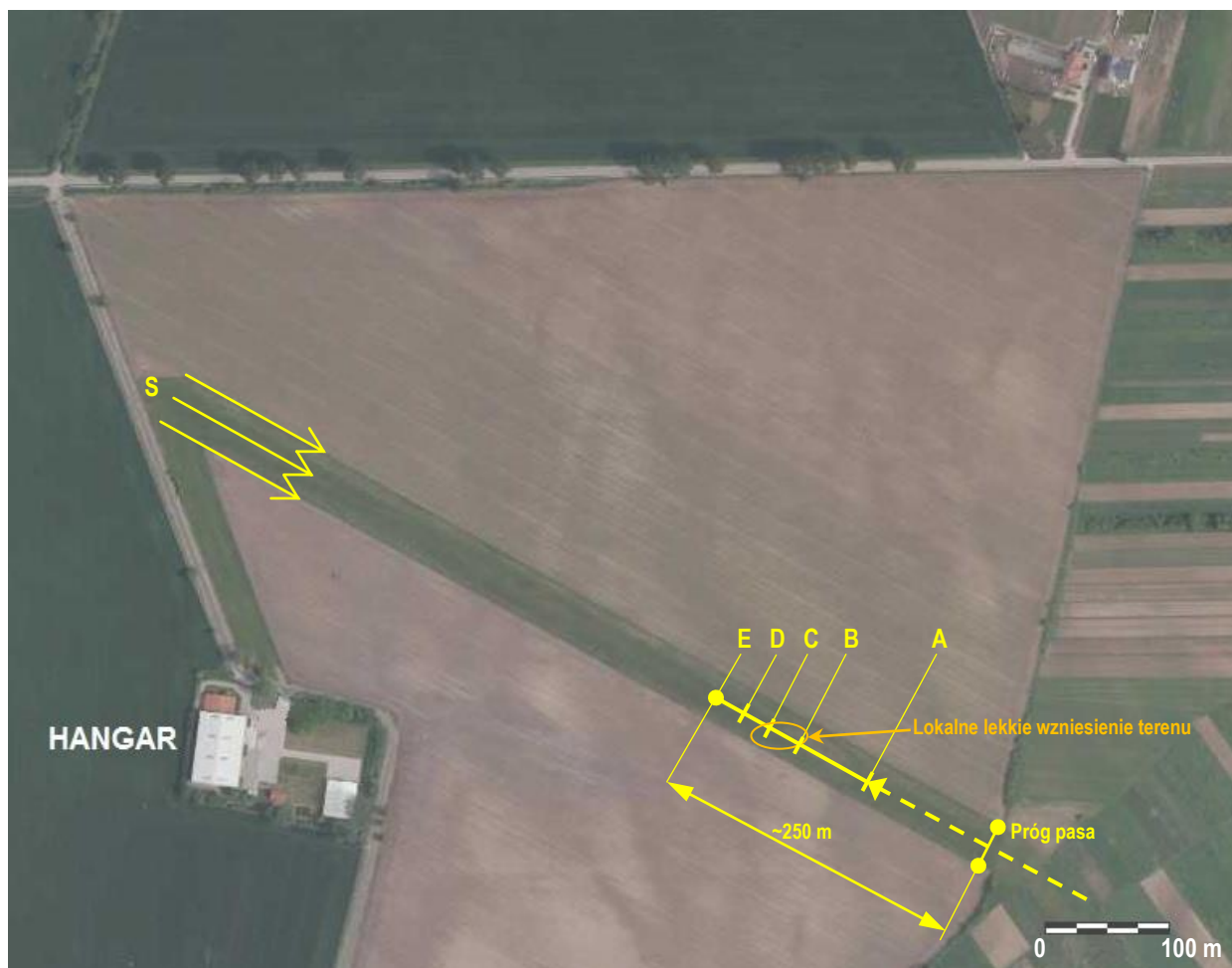
3 – Fotomapa lądowiska Konstancin – zaznaczone elementy sytuacyjne wypadku samolotu TS-8 Bies SP-YBD 10 kwietnia 2015 r. – podejście (linia przerywana), miejsce pierwszego przyziemienia z odbiciem przedniego podwozia (A), miejsce drugiego przyziemienia i odbicia przedniego podwozia (B), miejsce trzeciego przyziemienia i odbicia przedniego podwozia (C), miejsce czwartego przyziemienia i odłamania widelca z kołem podwozia przedniego (D), miejsce zatrzymania (E) oraz przybliżony kierunek padania promieni słonecznych (S) [podkład: geoportal].
