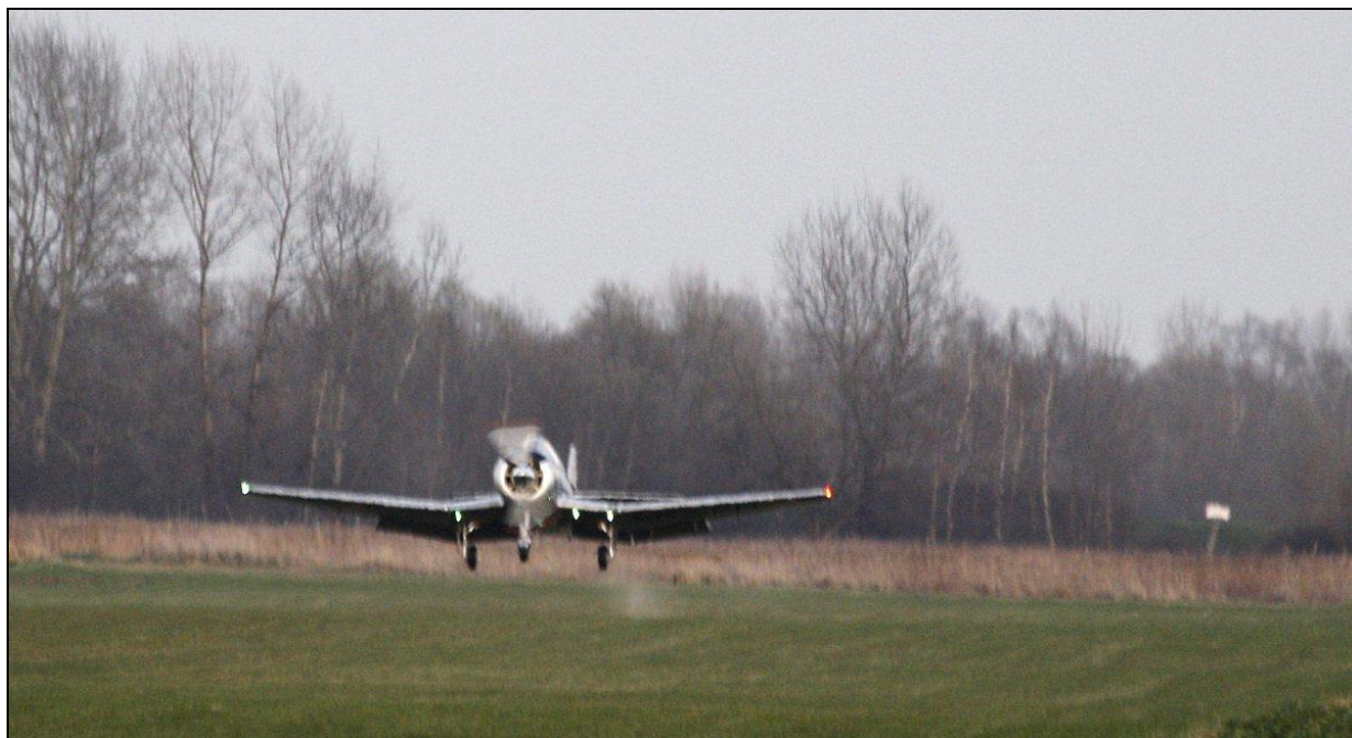
15 – Trzeci „kangur” (opuszczanie nosa po zdarciu) – odcinek C-D na ilustracji 4 [fot. Piotr Gliga].
