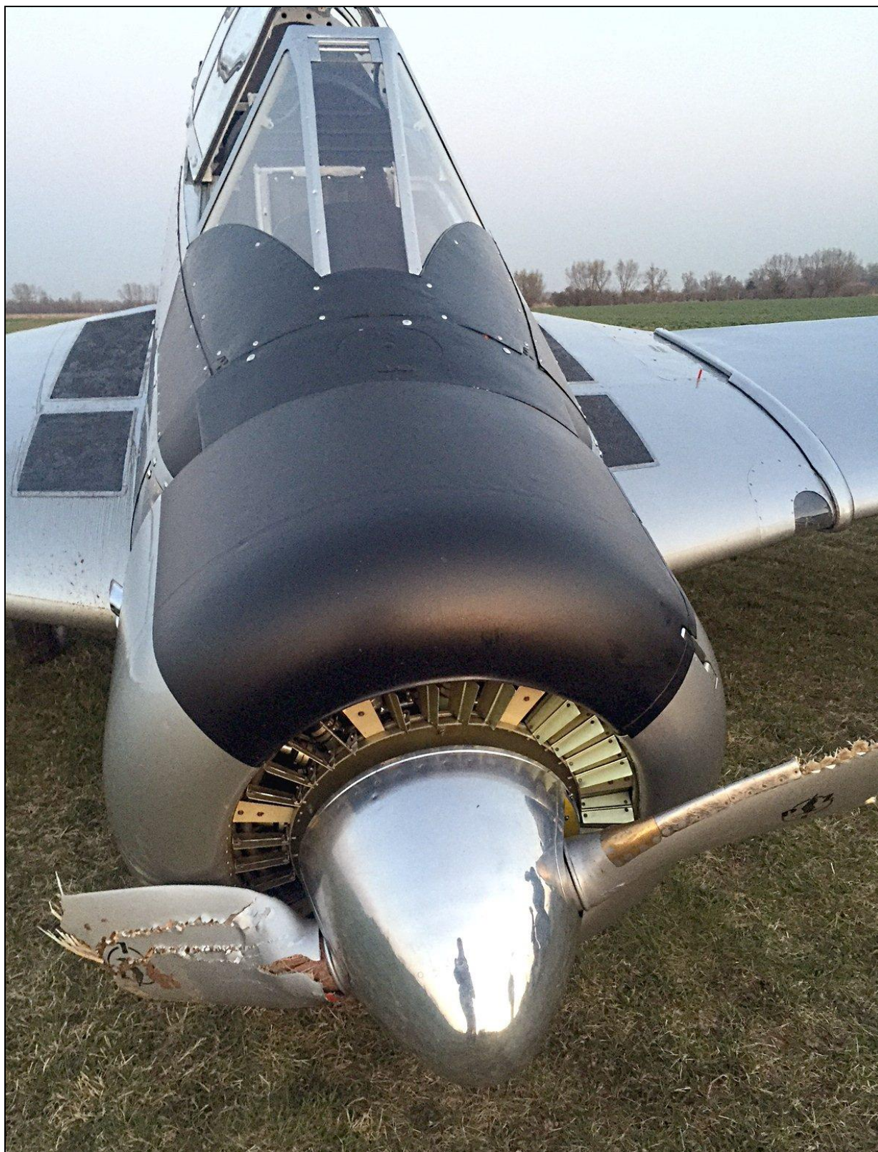
19 – Zbliżenie przedniej części kadłuba; dobrze widoczne zniszczone śmigło [fot.Użytkownik samolotu].
