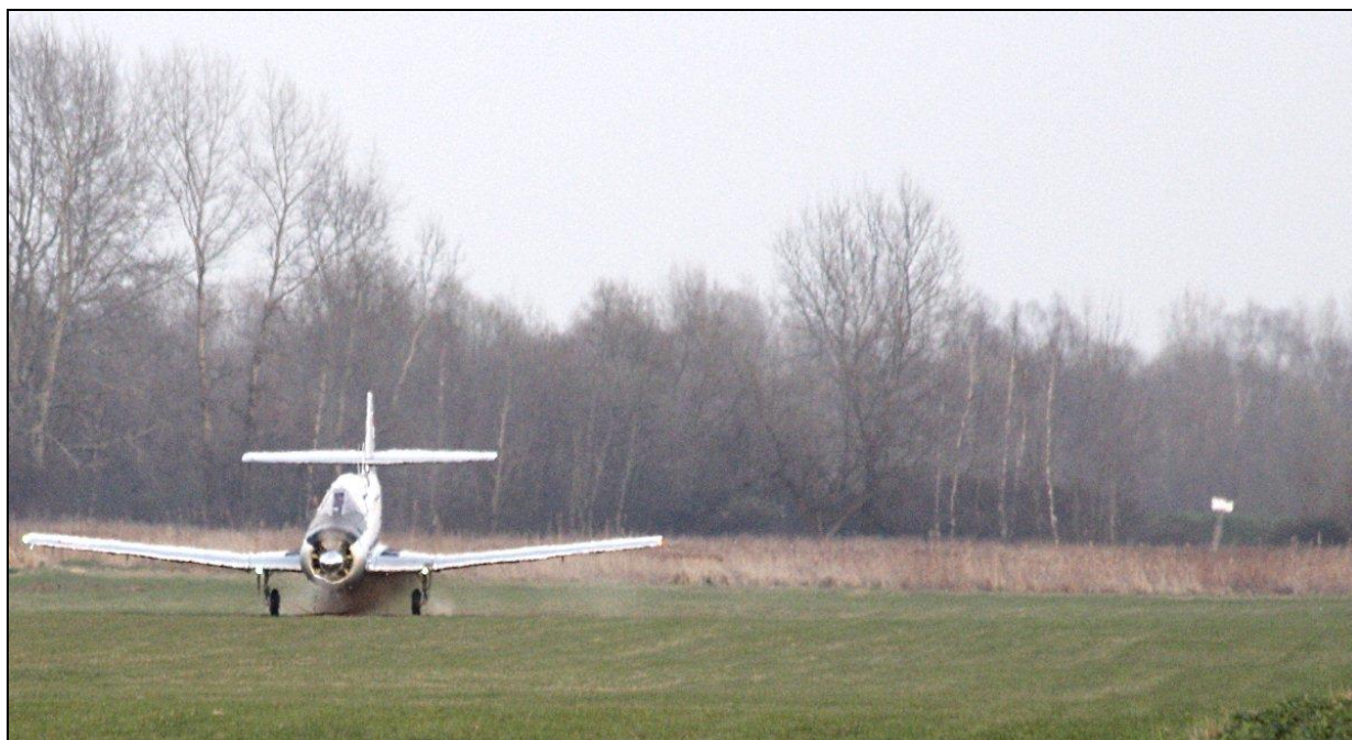
16 – Kontakt śmigła z nawierzchnią i rycie bruzdy przednim podwoziem po odłamaniu widelca z kołem – za punktem D na ilustracji 4 [fot. Piotr Gliga].
