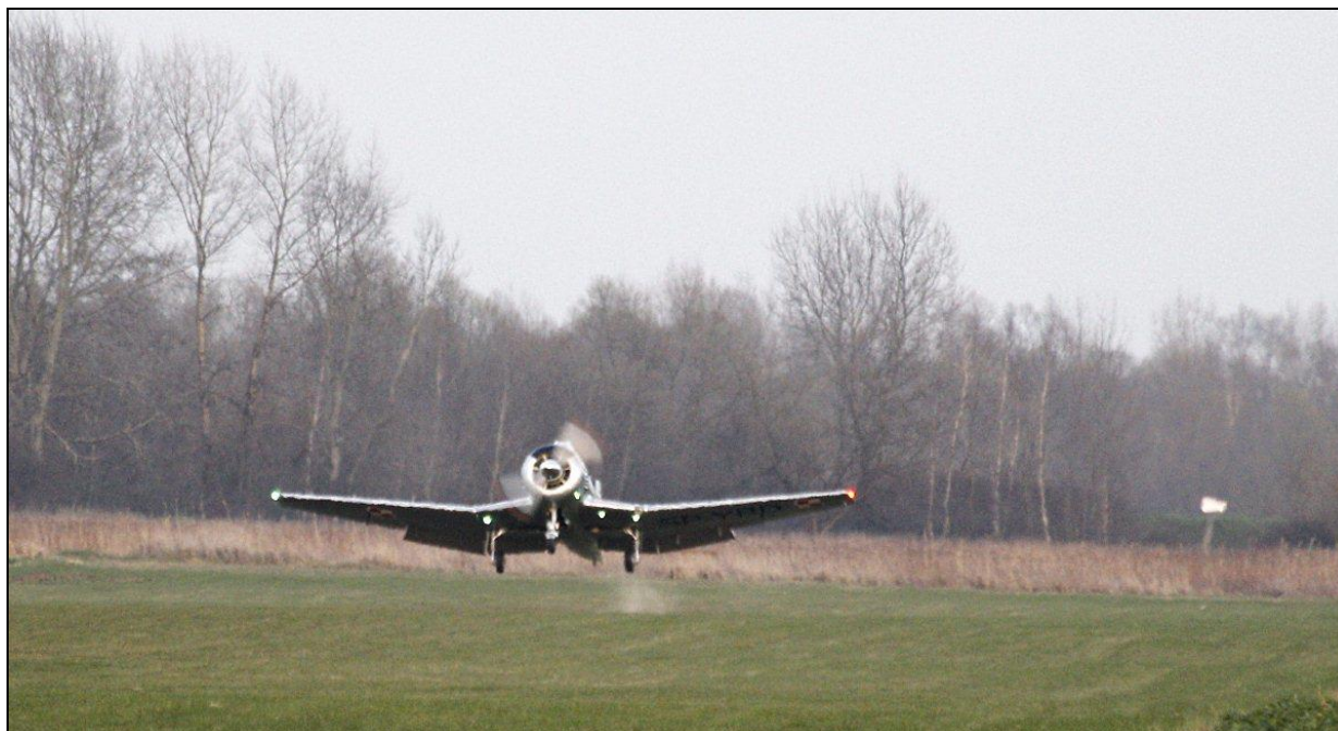
14 – Trzeci „kangur” (zadarcie tuż po odbiciu) – odcinek C-D na ilustracji 4 [fot. Piotr Gliga].
