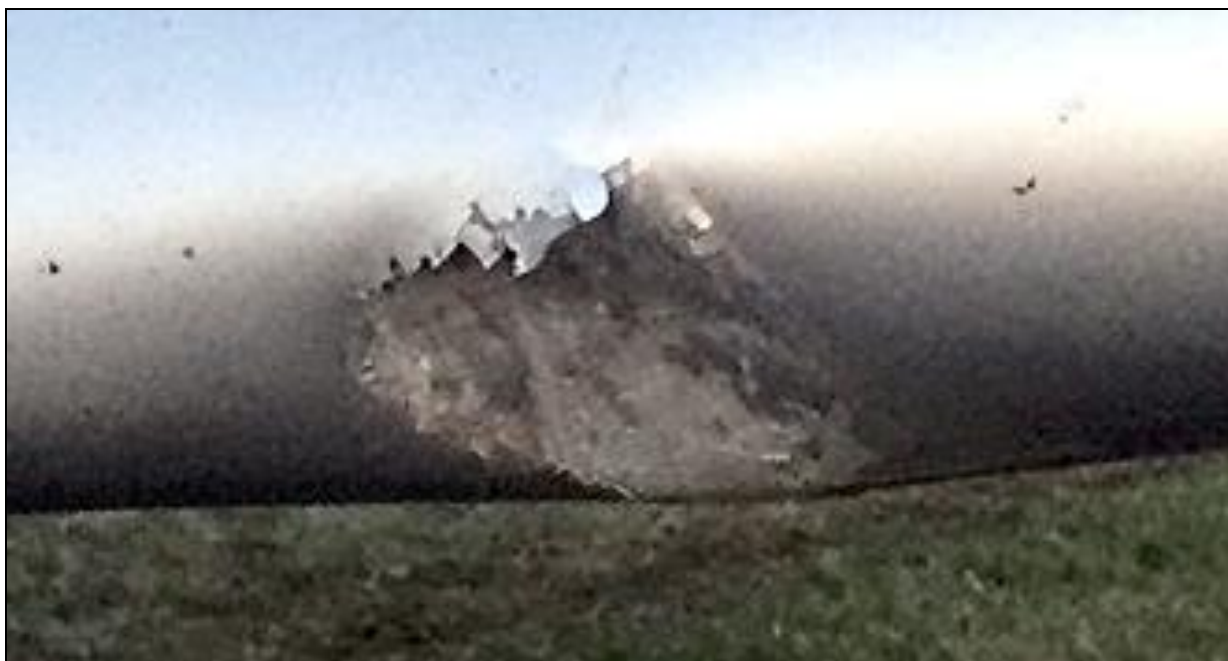
23 – Wgniecenie noska lewego skrzydła spowodowane uderzeniem odłamanej widelca podwozia przedniego [fot.Użytkownik samolotu].
