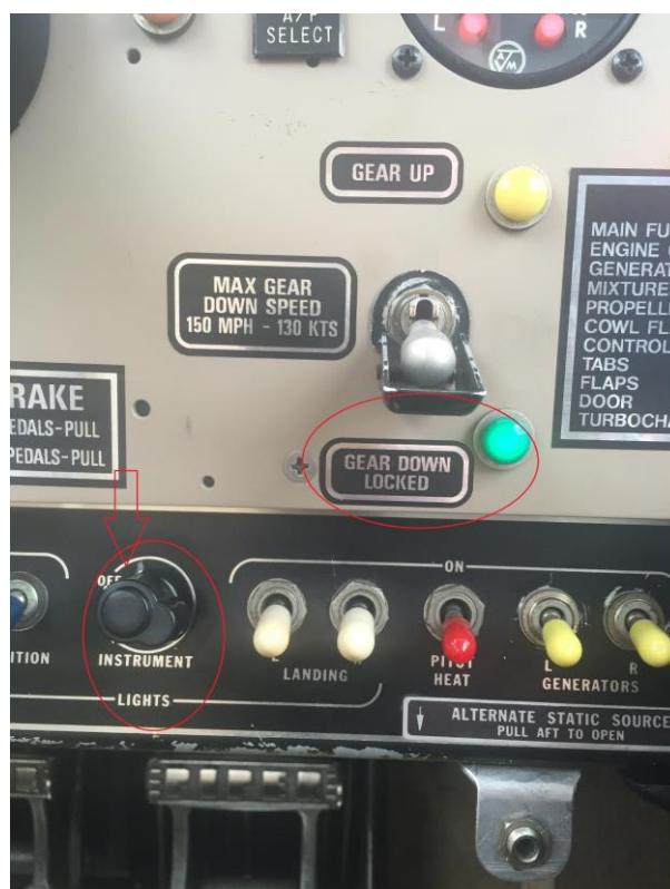
Załącznik 1 - Sygnalizacja wypuszczenia podwozia przy wyłączonym oraz włączonym podświetleniu tablicy przyrządów samolotu PA-30
