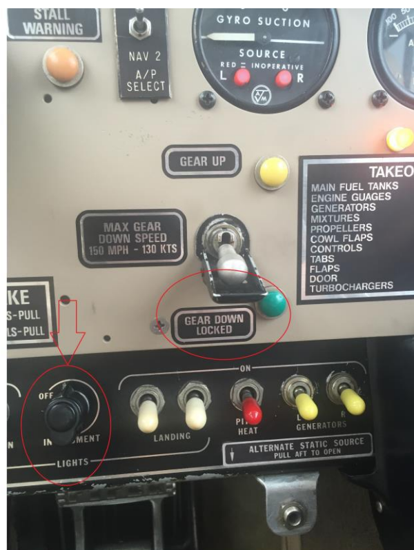
Załącznik 1 - Sygnalizacja wypuszczenia podwozia przy wyłączonym oraz włączonym podświetleniu tablicy przyrządów samolotu PA-30
