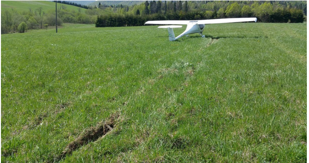
Rys.2. Lokalne nierówności nawierzchni łąki, które spowodowały wylamanie przedniej goleńi podwozia. Zdjęcie pokazuje stan po ustawieniu samolotu na kołach.
