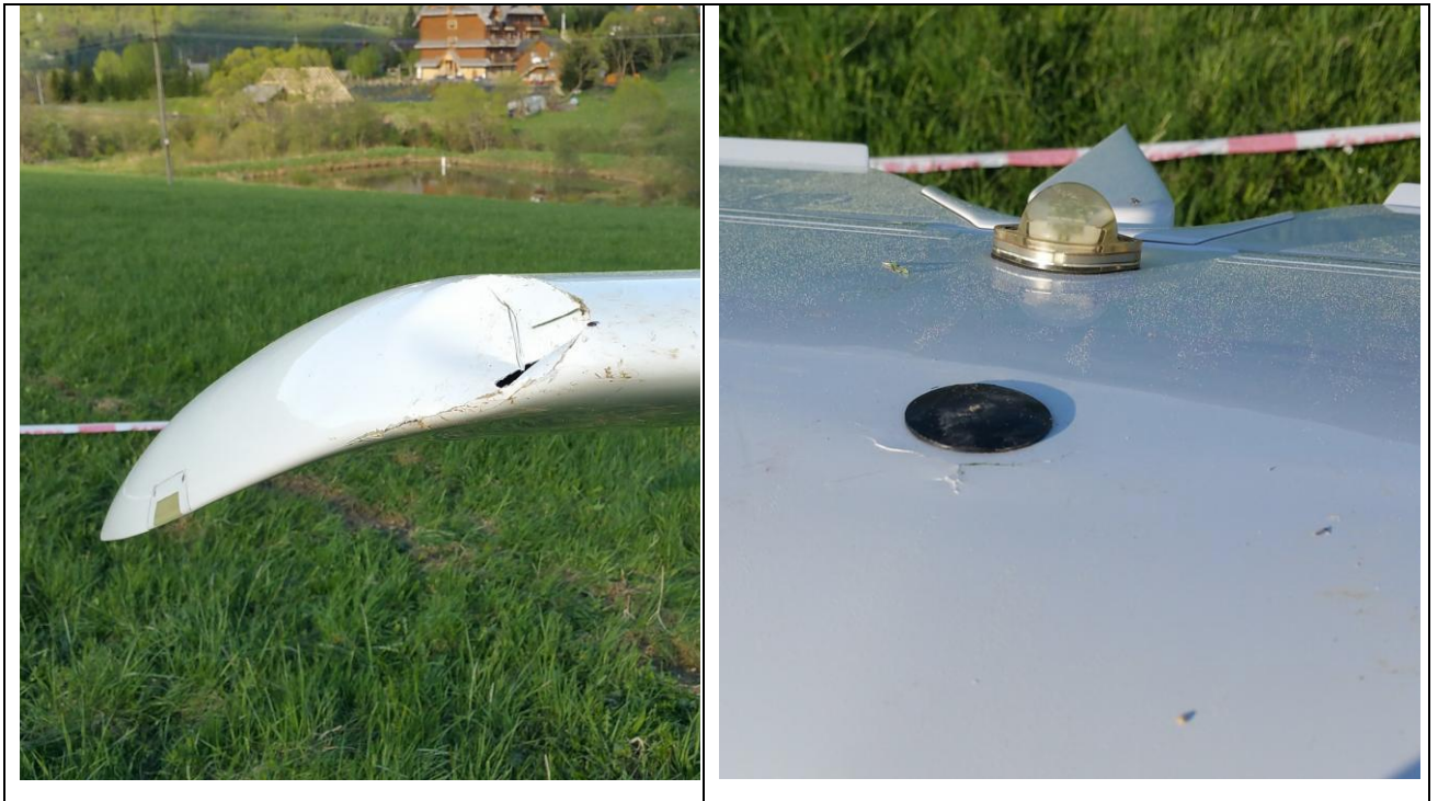
Rys.5 i 6. Uszkodzenia końcówki i pokrycia centralnej części prawego skrzydła. Na zdjęciu po lewej widoczny w głębi hotel Carpatia.
