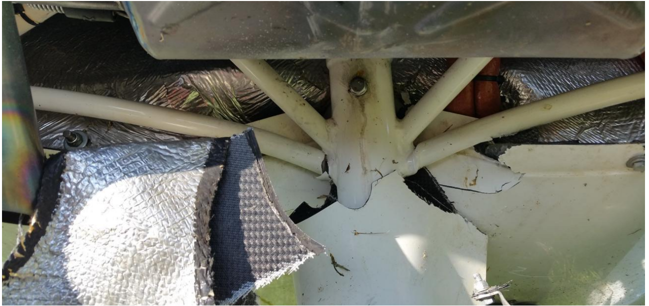
Rys.4. Uszkodzenia łoża silnika i ściany ogniowej
