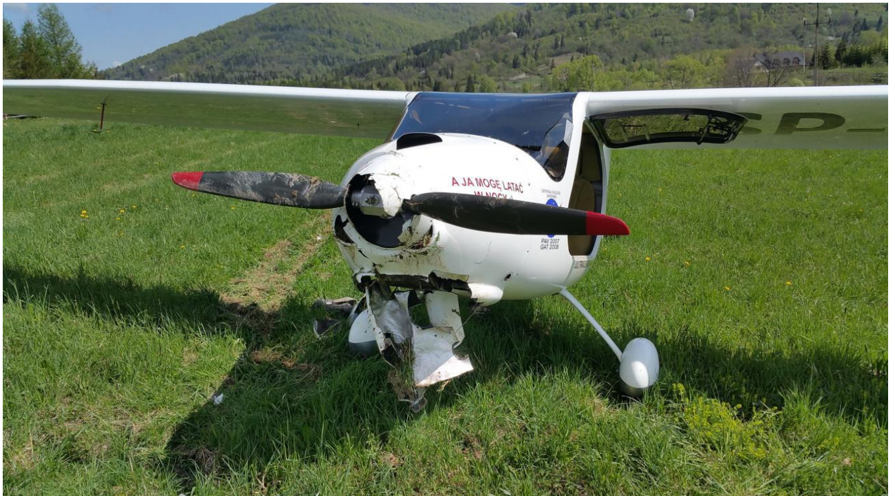
Rys.3. Uszkodzenia przedniej części samolotu – widoczne, wylamane koło i przednia goleń, zniszczony kołpak i tarcza śmigła, uszkodzone osłony silnika.
