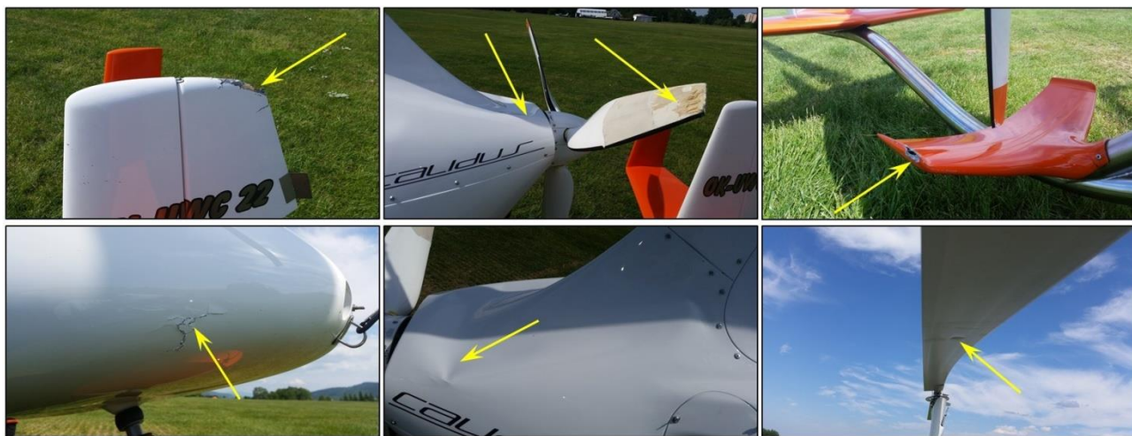
Fot. 2,3, 4, 5, 6, 7. Uszkodzenia wiatrakowca Calidus, OK.-UWC 22 [zdjęcia: użytkownik]
