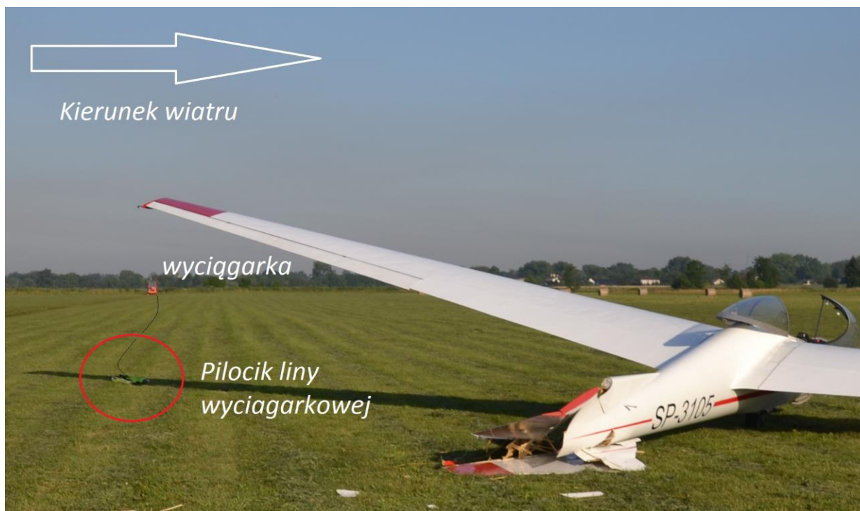
Widok na wyciągarkę i uszkodzony szybowiec. Widoczny pilocik liny wyciągarkowej.
