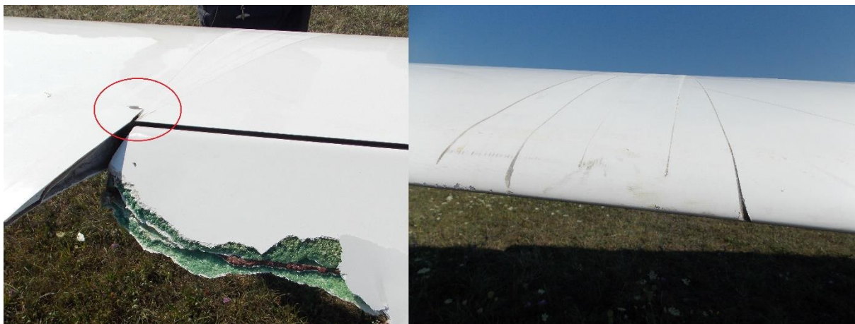
Rys. 8. Na zdjęciu pokazano ślady, jakie pozostawiła lina na skrzydle szybowca [źródło: PKBWL]
