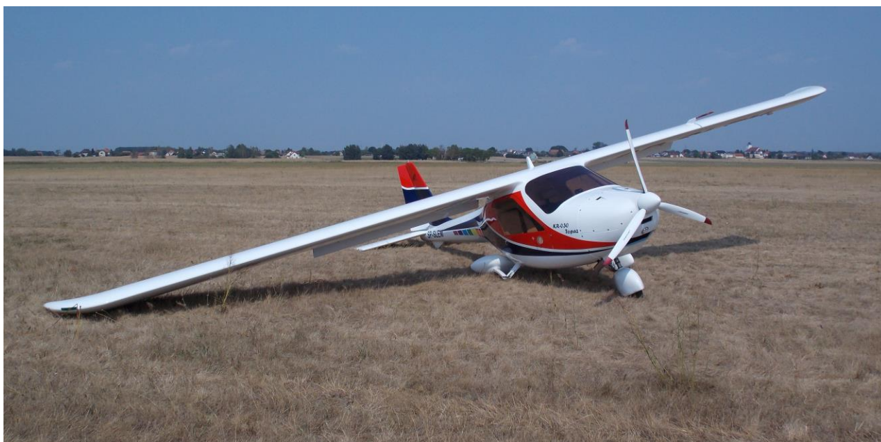
Rys.1. Położenie samolotu na miejscu zdarzenia po lądowaniu. Widoczna złamana goleń prawego podwozia głównego [foto PKBWL].
