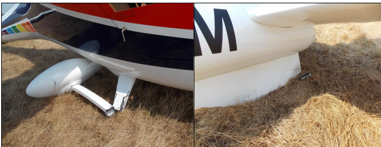
Rys.2 i 3. Złamana goleń prawego podwozia głównego, po lewej oraz uszkodzona płoza ogonowa, po prawej [foto PKBWL].
