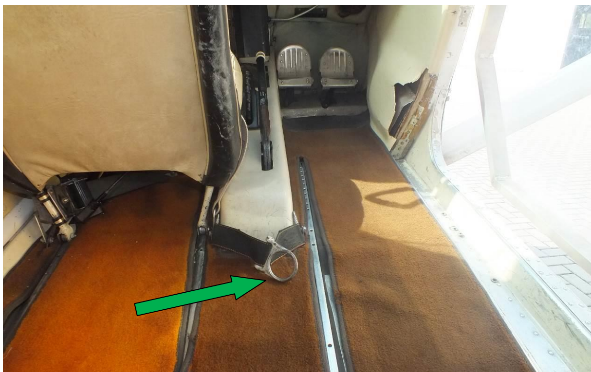
Fot.3 Widok z tyłu kabiny samolotu na oznaczone zieloną strzałką okucie do mocowania karabińczyków lin desantowych.
