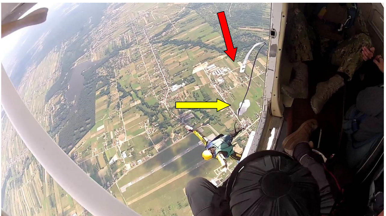
Fot. 2. Czerwoną strzałką zaznaczono otwarty karabińczyk, po wysunięciu się z samolotu całej liny desantowej. Żółtą strzałką zaznaczono pilotik czaszy głównej.
