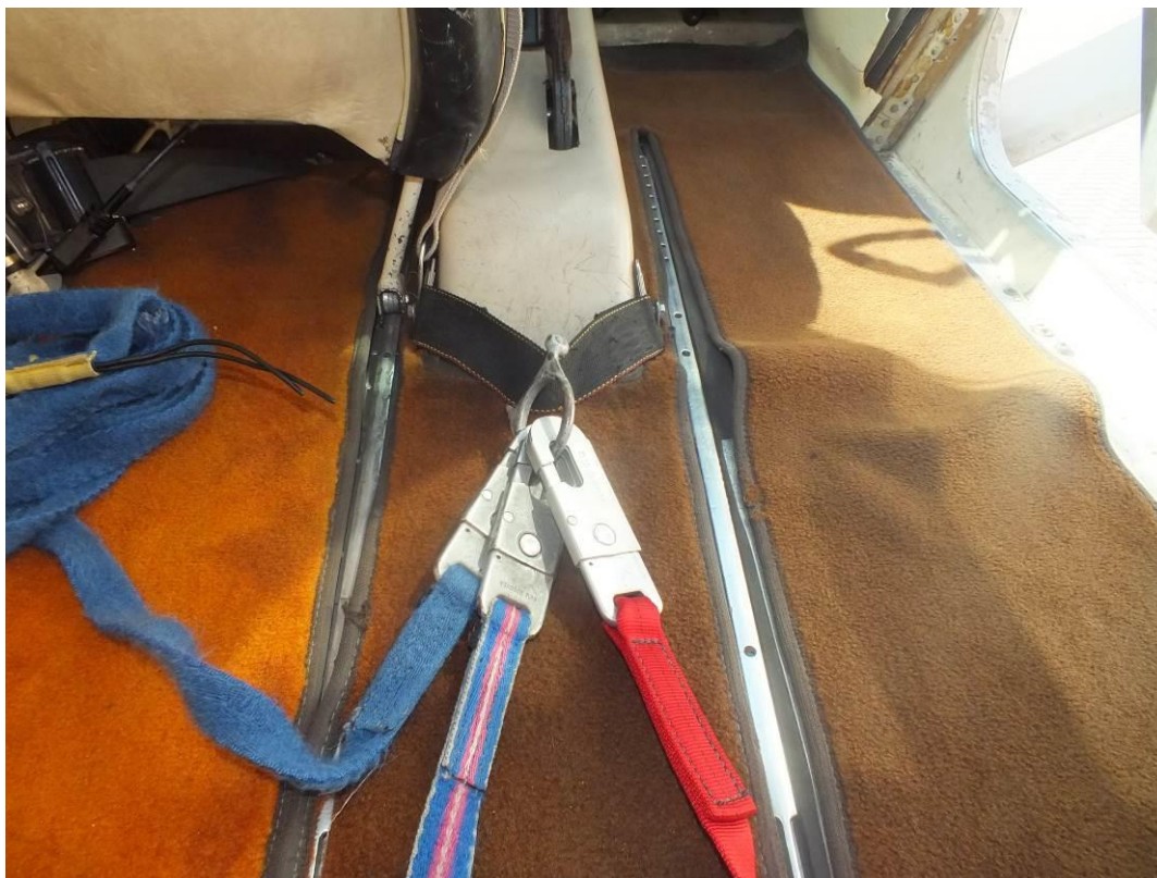
Fot. 4 Widok z tyłu kabiny na prawidłowo zapięte i zablokowane karabińczyki lin desantowych.
