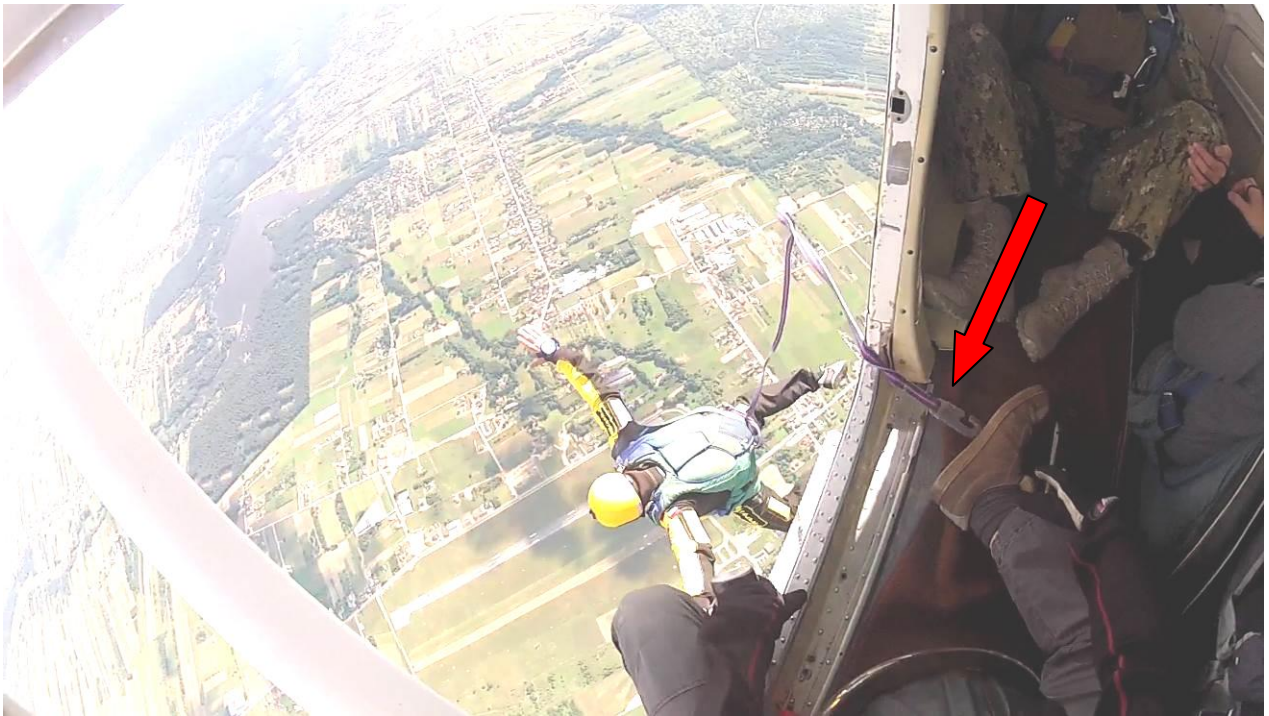
Fot. 1. Czerwoną strzałką zaznaczono otwarty karabińczyk, wysuwający się spod stopy instruktora. Komora czaszy głównej jest jeszcze zamknięta.
