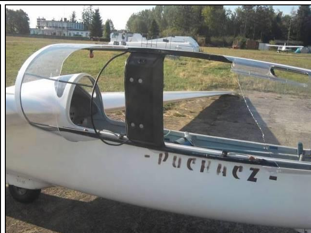
Rys.1÷3 Szybowiec SZD-50-3 Puchacz ze zniszczonym oszkleniem osłony kabiny (fot. podmiot badający)
