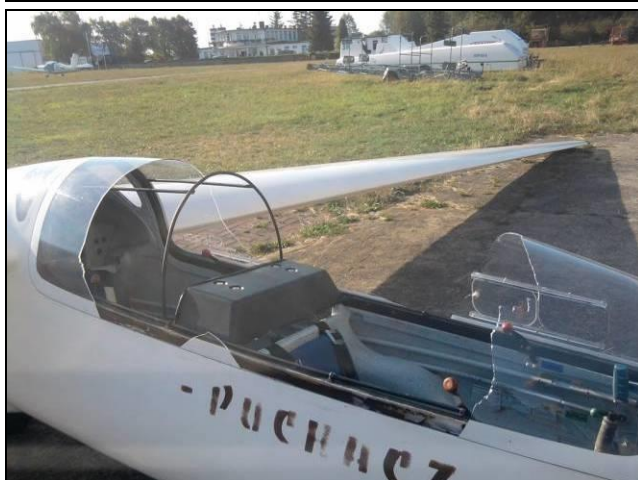
Rys.1÷3 Szybowiec SZD-50-3 Puchacz ze zniszczonym oszkleniem osłony kabiny (fot. podmiot badający)
