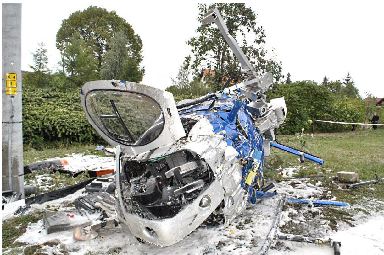
15 – Widok przedniej części i spodu kadłuba rozbitego śmigłowca od strony południowej [foto: Policja].
