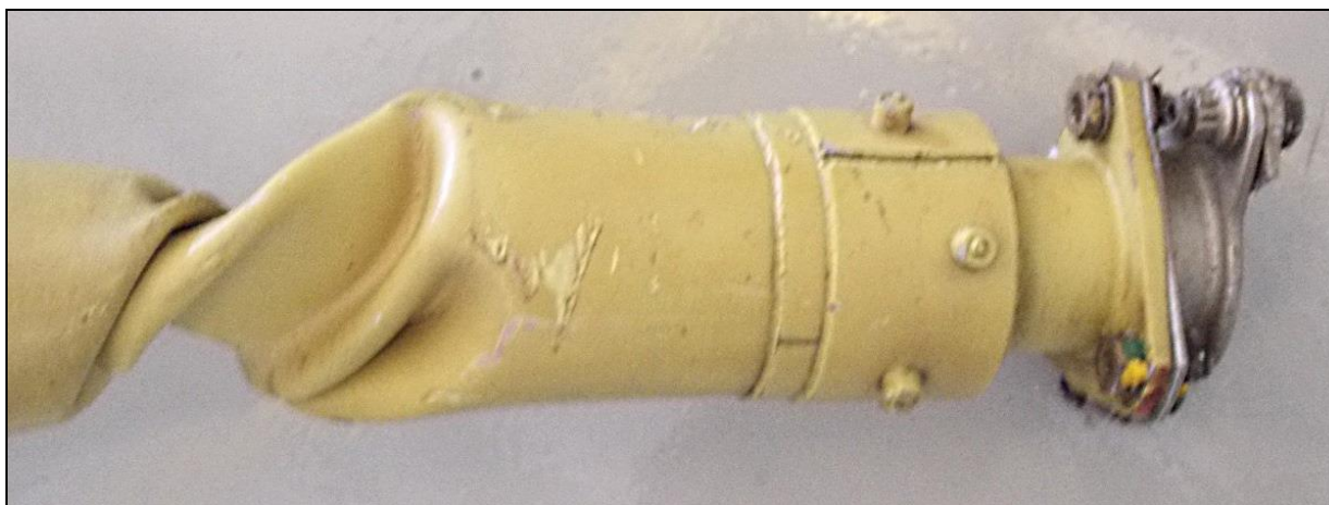
41 – Końcowy odcinek zniszczonego wału napędowego śmigła ogonowego z widoczną strefą skręcenia i rozerwanym sprzęgłem przekazania napędu na przekładnię kątową.
