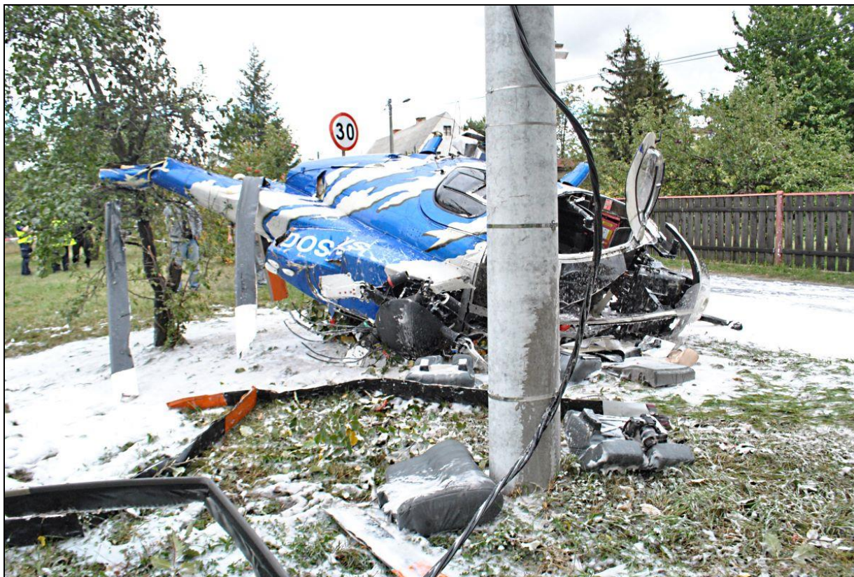
12 – Widok grzbietu kadłuba rozbitego śmigłowca od strony południowej. Obok zniszczone łopaty wirnika głównego. [foto: Policja].
