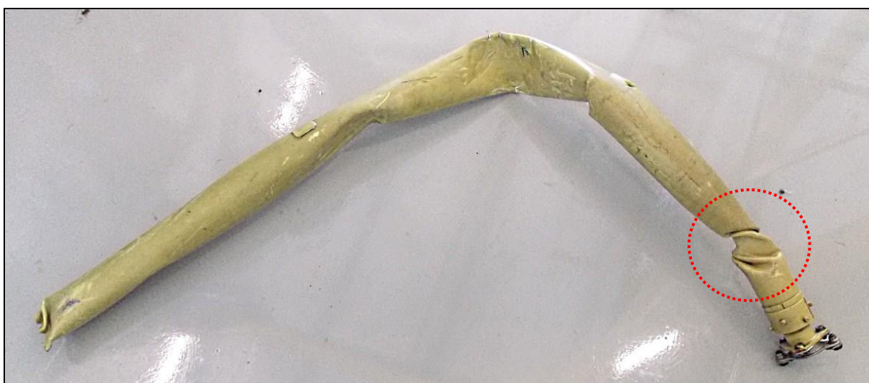
39 – Końcowy fragment wału napędowego śmigła ogonowego. Dobrze widoczna strefa skrzywienia, które wystąpiło przed zniszczeniem wału.
