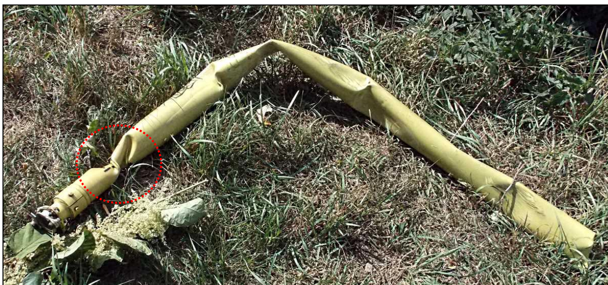
38 – Końcowy fragment wału napędowego śmigła ogonowego. Dobrze widoczna strefa skrzywienia, które wystąpiło przed zniszczeniem wału.
