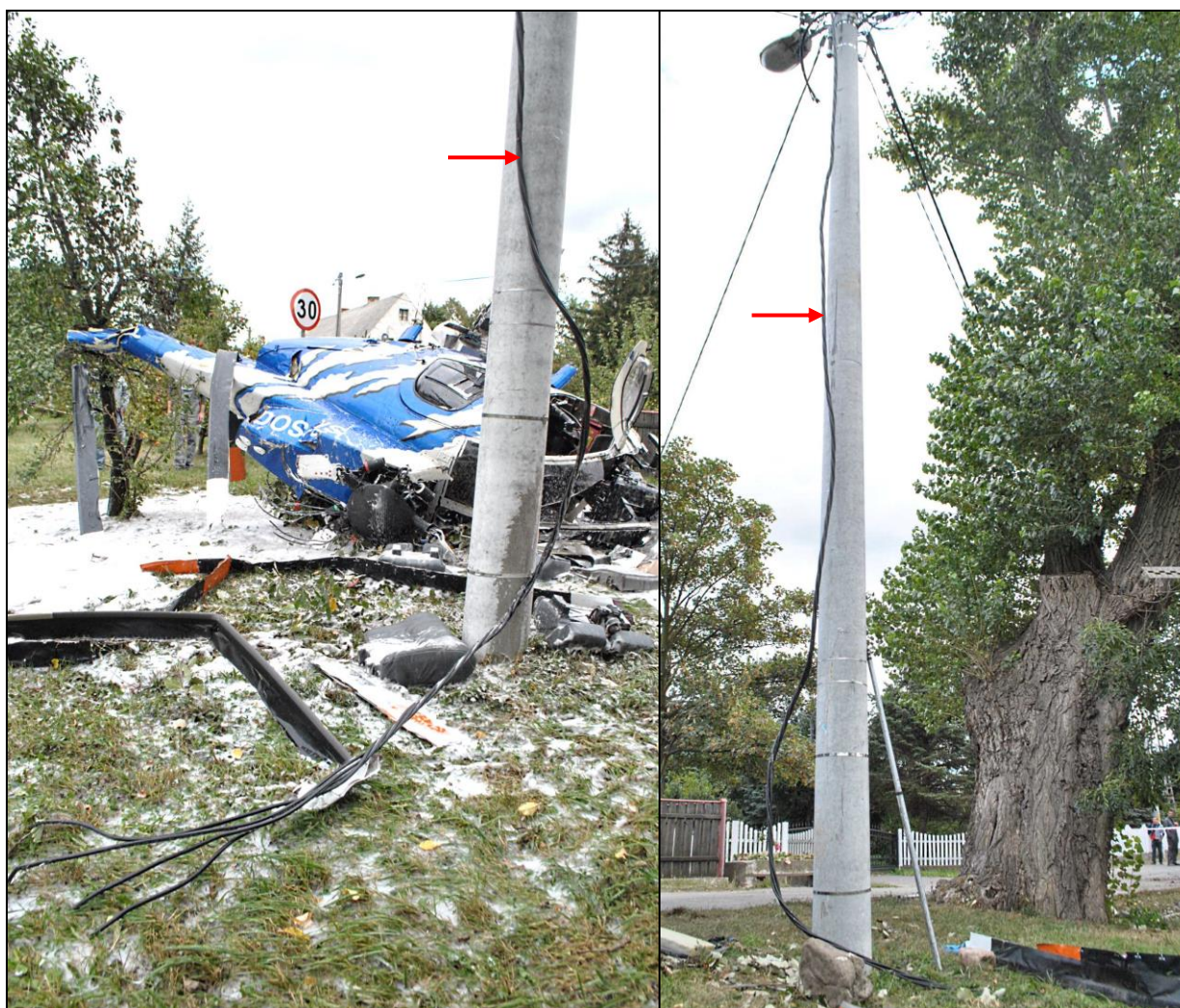
8 – Miejsce wypadku od strony północnej. Zwraca uwagę zerwany przewód linii energetycznej. [foto: Policja].
