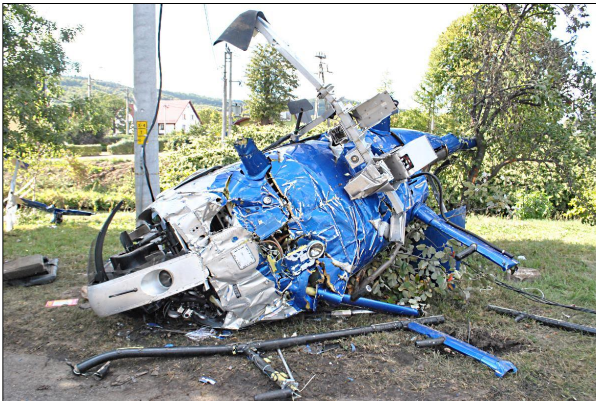
16 – Spód przedniej części kadłuba. Widoczne zniszczone podwozie i poprzeczna belka z czujnikami aparatury pomiarowej [foto: Policja].
