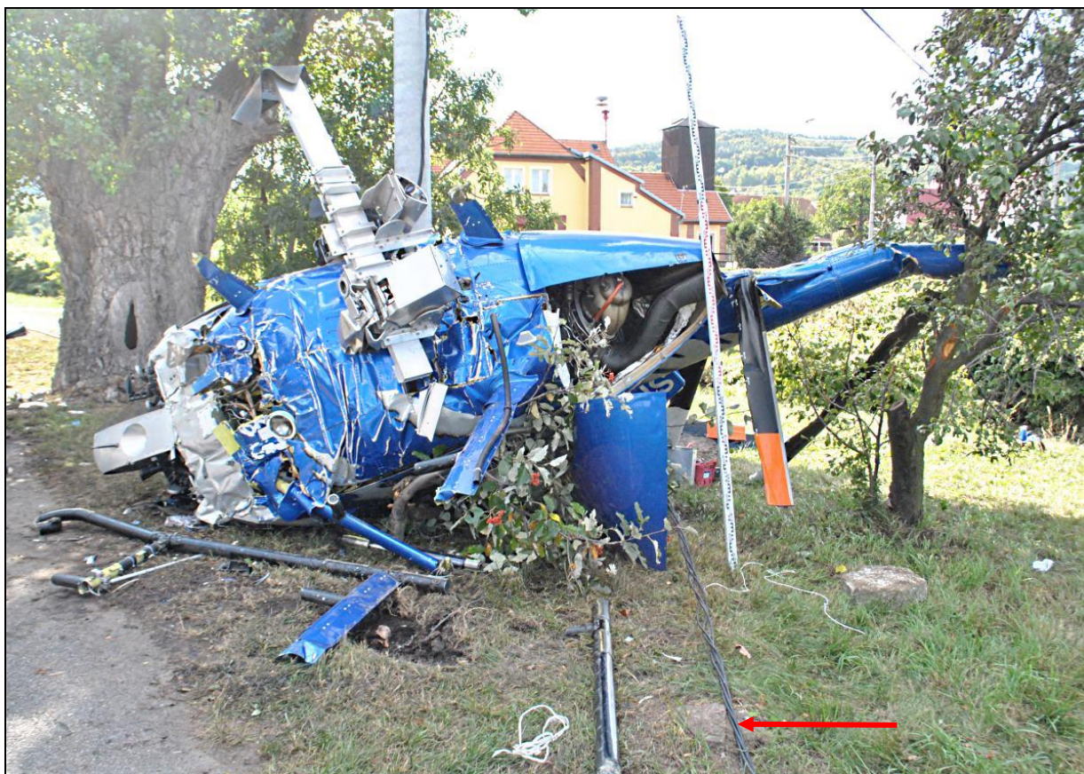
17 – Spód kadłuba. Widoczne zniszczone podwozie i poprzeczna belka z czujnikami aparatury pomiarowej oraz częściowo otwarty przedział silnika. Widoczny zerwany przewód linii energetycznej. [foto: Policja].
