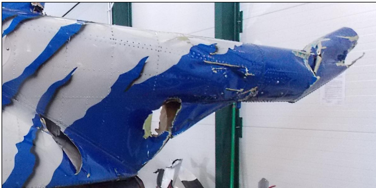
28 – Zniszczona belka ogonowa, lewa strona.
