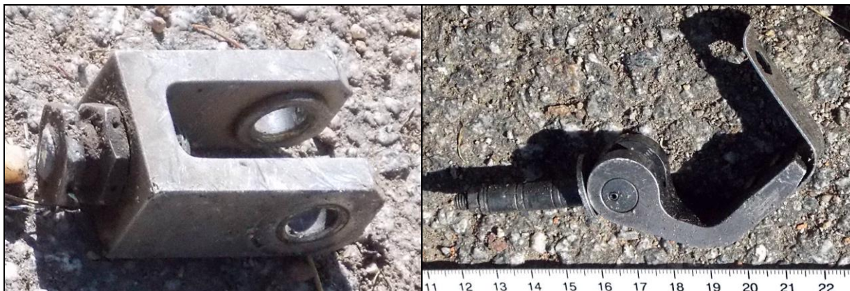
36, 37 – Oderwane elementy układu sterowania śmigłem ogonowym.
