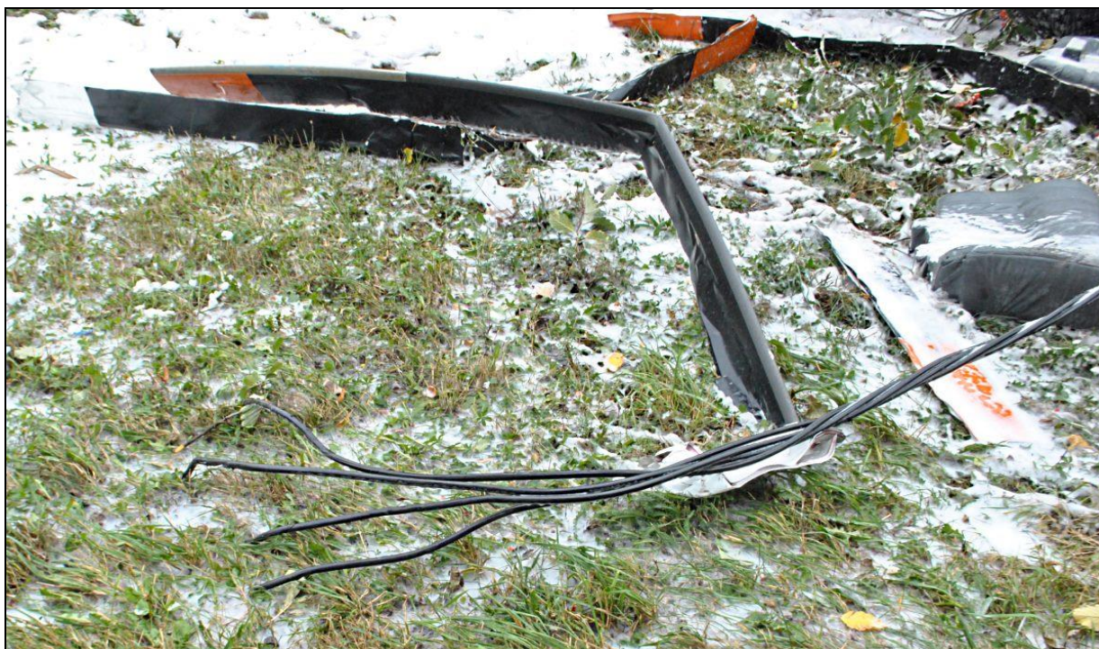
25 – Połamane łopaty wirnika głównego i koniec zerwanego przewodu linii energetycznej. [foto: Policja].
