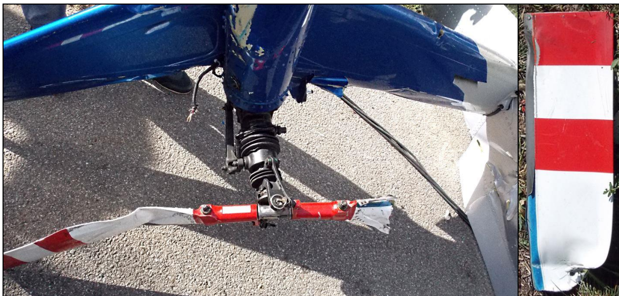
33, 34 – Zakończenie belki ogonowej z przekładnią kątową oraz głowica zniszczonego śmigła ogonowego; po prawej odłamany fragment łopaty śmigła.
