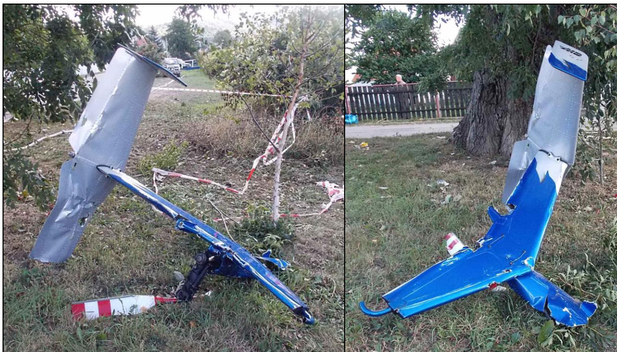
29, 30 – Oderwane od belki ogonowej usterzenie z przekładnią kątową i zniszczonym śmigłem ogonowym.
