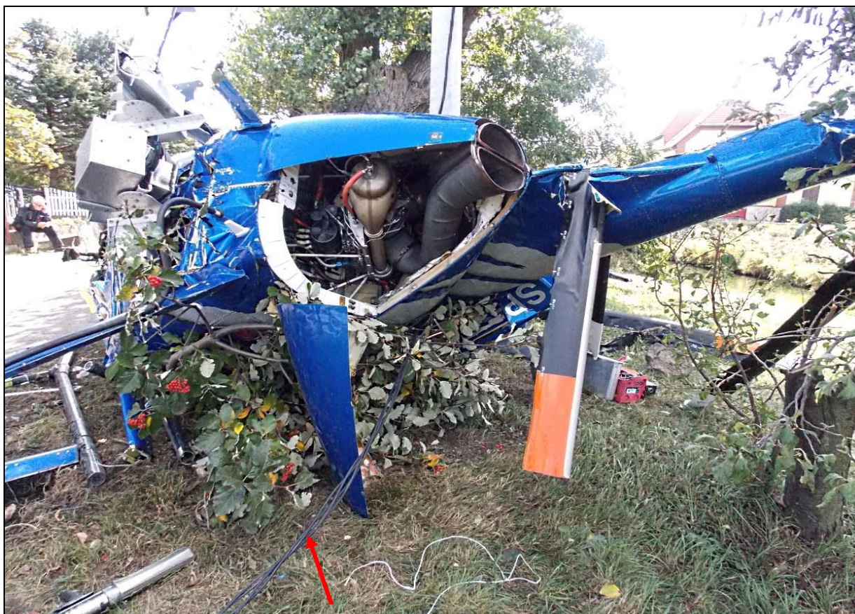
19 – Spód kadłuba od tyłu. Widoczny częściowo otwarty przedział silnika, zniszczona belka ogonowa i jedna z łopát wirnika głównego. Na pierwszym planie zerwany przewód linii energetycznej.
