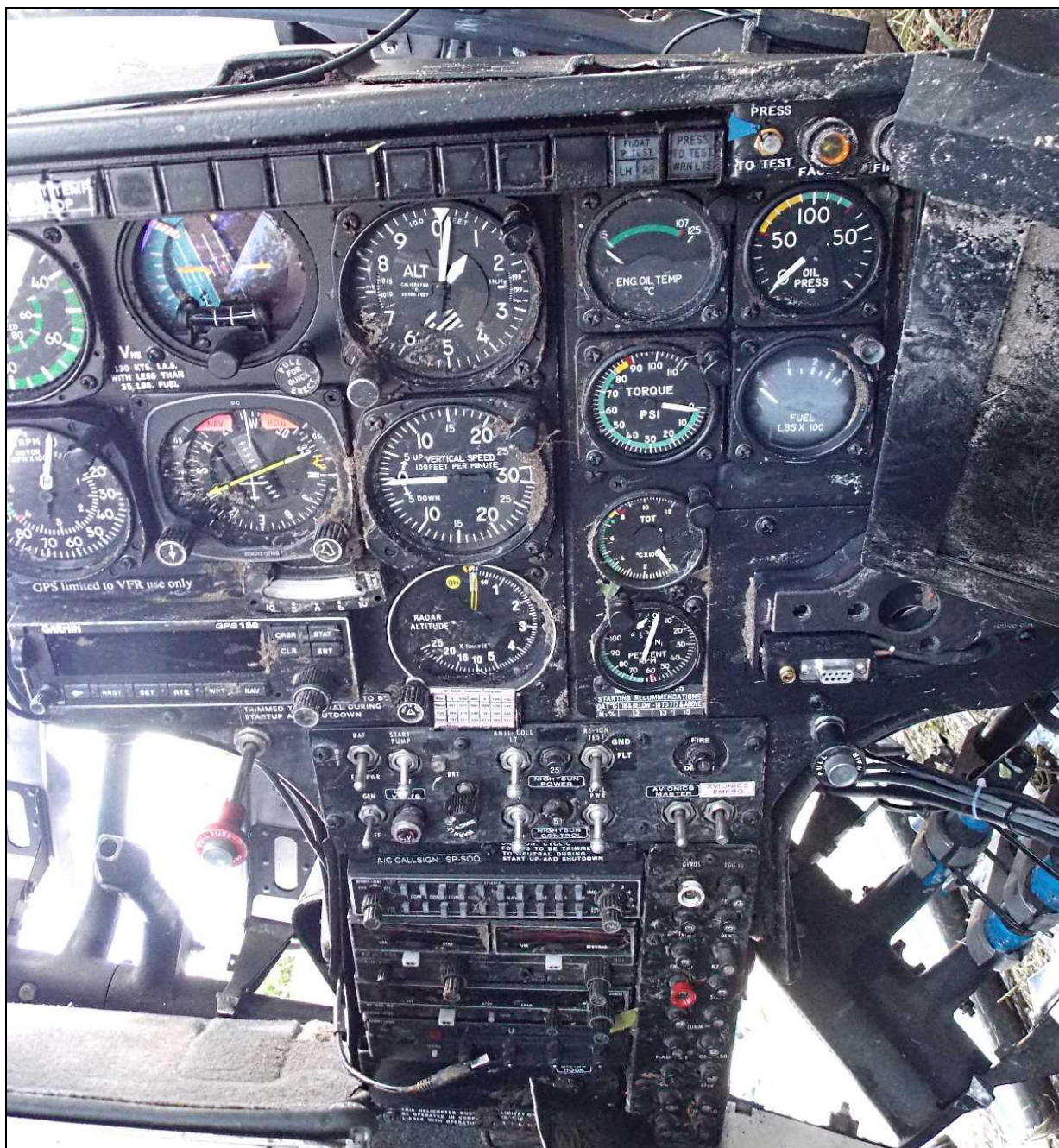
47 – Tablica przyrządów oraz pulpit wyposażenia radiowego i radionawigacyjnego.
