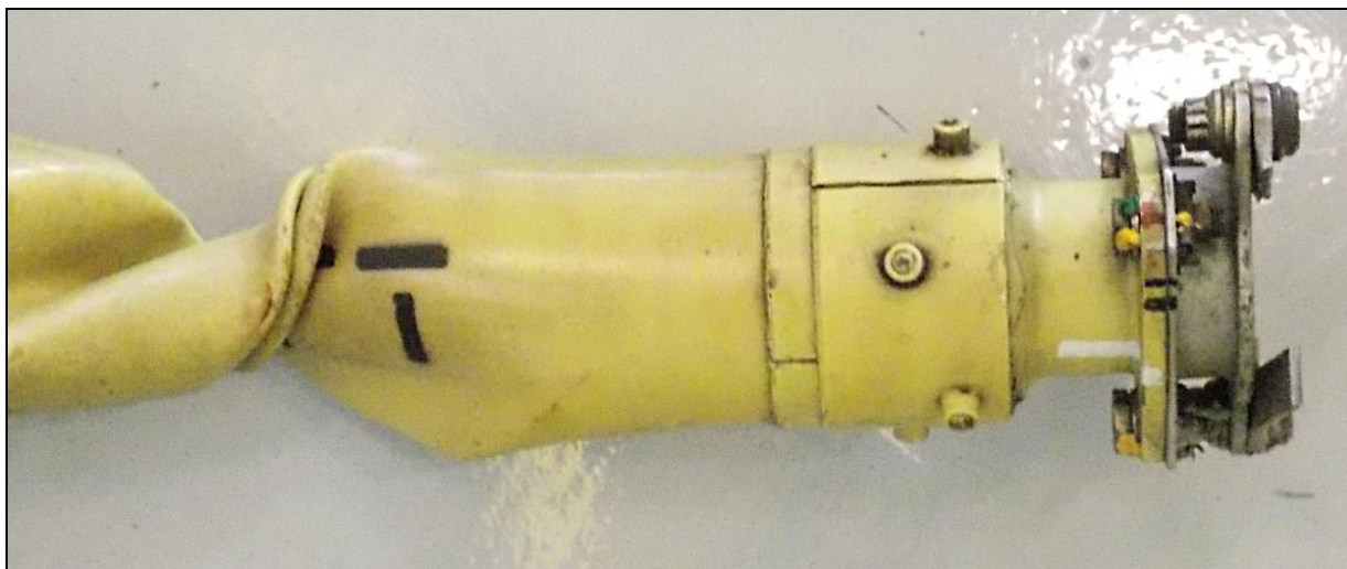
40 – Końcowy odcinek zniszczonego wału napędowego śmigła ogonowego z widoczną strefą skręcenia i rozerwanym sprzęgłem przekazania napędu na przekładnię kątową.
