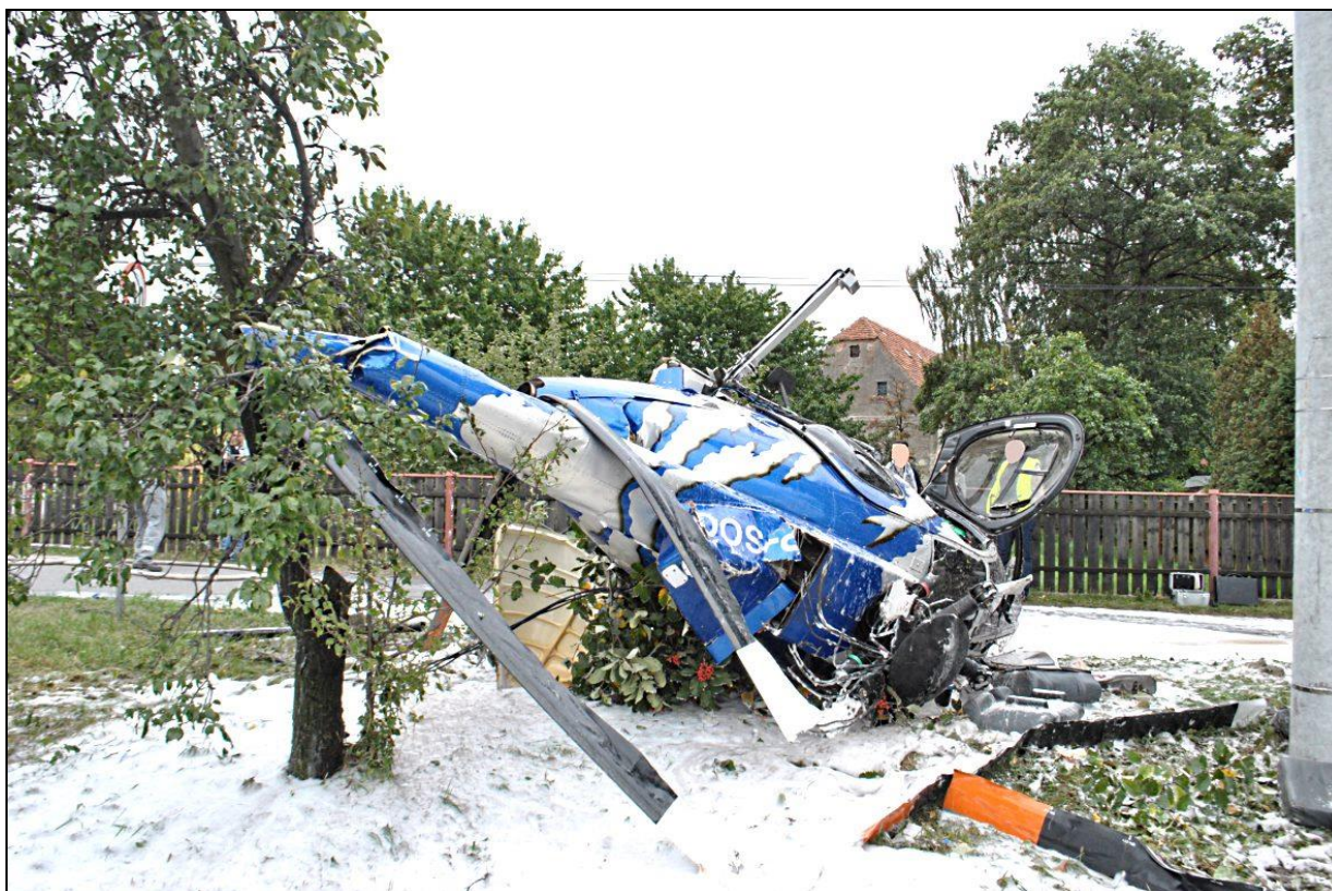
11 – Widok rozbitego śmigłowca od strony zachodniej. Widoczny grzbiet kadłuba i zniszczone łopaty wirnika głównego [foto: Policja].
