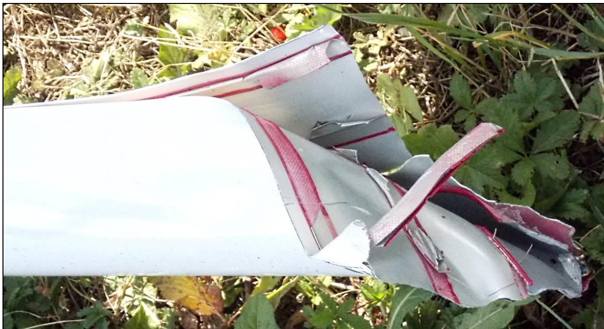
26 – Typowe zniszczenie krawędzi spływu łopat wirnika głównego.
