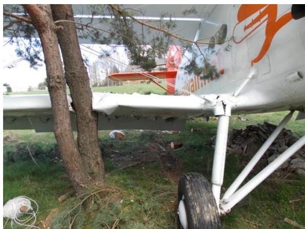
Rys. 6. Uszkodzenia prawych skrzydeł – szczegóły.[foto PKBWL]
