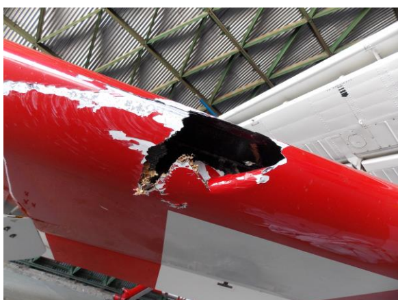
Rys.5. Uszkodzenia kesonów lewego i prawego skrzydła.
