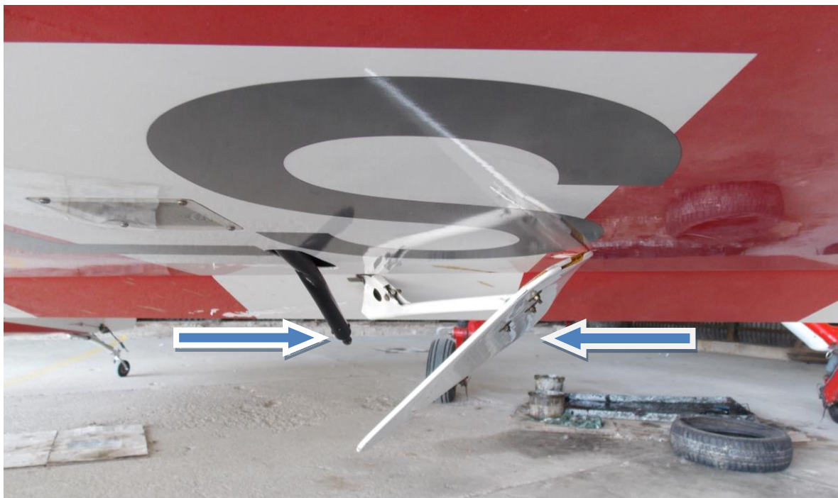
Rys.4. Uszkodzenia lotki lewej. Widoczny urwany popychacz napędu lotki oraz odgięta płytka wyważająca lotkę lewą, w położeniu ograniczającym wychylenia lotki.
