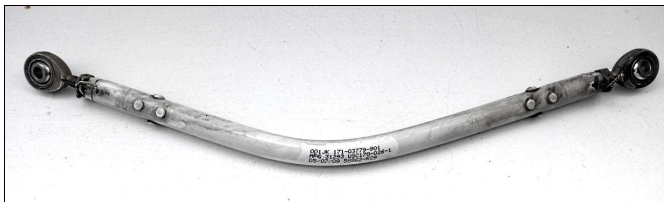
Uszkodzony (zgięty) popychacz górny PN 171-03779-901.
