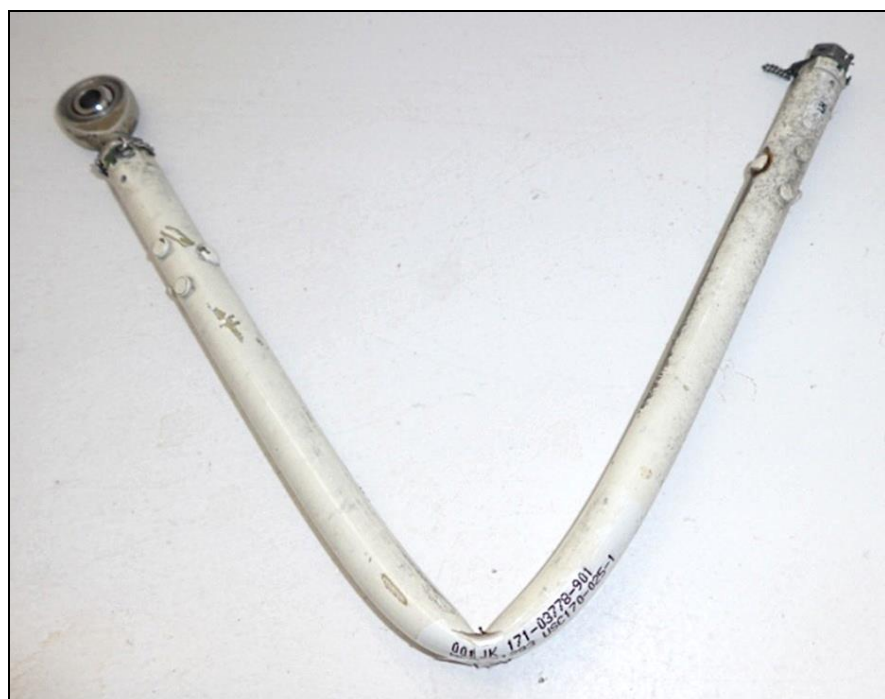
Uszkodzony (złamany) popychacz dolny PN 171-03778-901 z urwaną końcówką.
