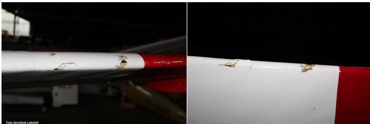
Ilustracja nr 3. Uszkodzone skrzydło szybowca.
