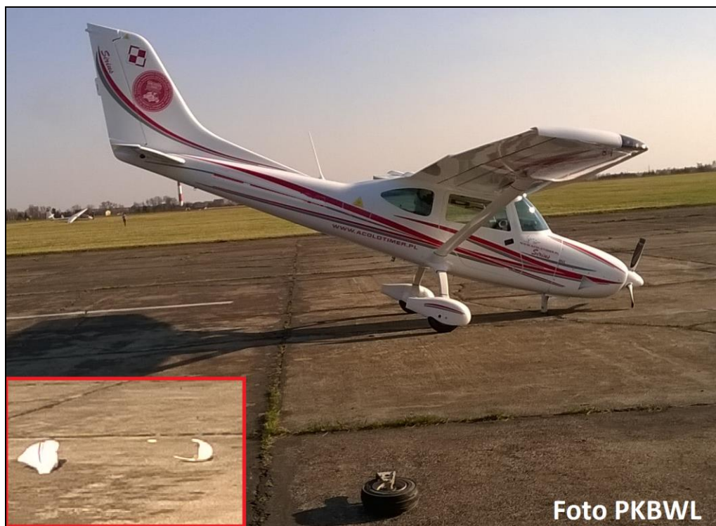
Ilustracja nr 2. Uszkodzony samolot po lądowaniu. Widoczne odłamane koło podwozia przedniego, zniszczona owiewka przedniego koła oraz uszkodzone śmigło.
