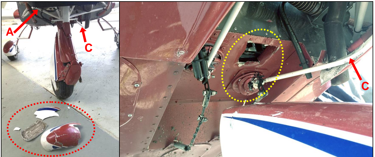
4, 5 – Uszkodzenia samolotu – zgięcie wybożeniowe pręta łoża silnika (A) i zgięcie wybożeniowe lewego popychacza sterowania podwoziem przednim (C), zaznaczona (kolorem czerwonym) zniszczona owiewka koła przedniego podwozia oraz (kolorem żółtym) strefa uszkodzeń dolnego pokrycia kadłuba za przegrodą ogniową [fot. Użytkownik samolotu].
