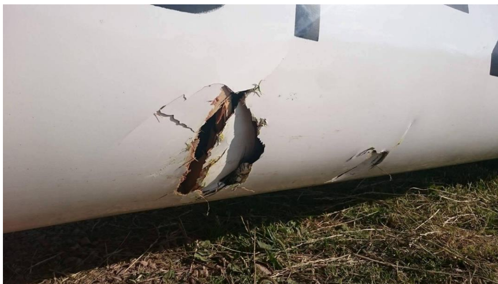
Ilustracja nr 3. Widoczne uszkodzenia szybowca.
