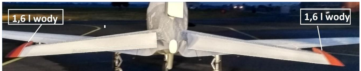
Rys. 7. Ilość wody, jaką wlano do usterzenia poziomego [źródło: PKBWL, pilot oblatywacz]
