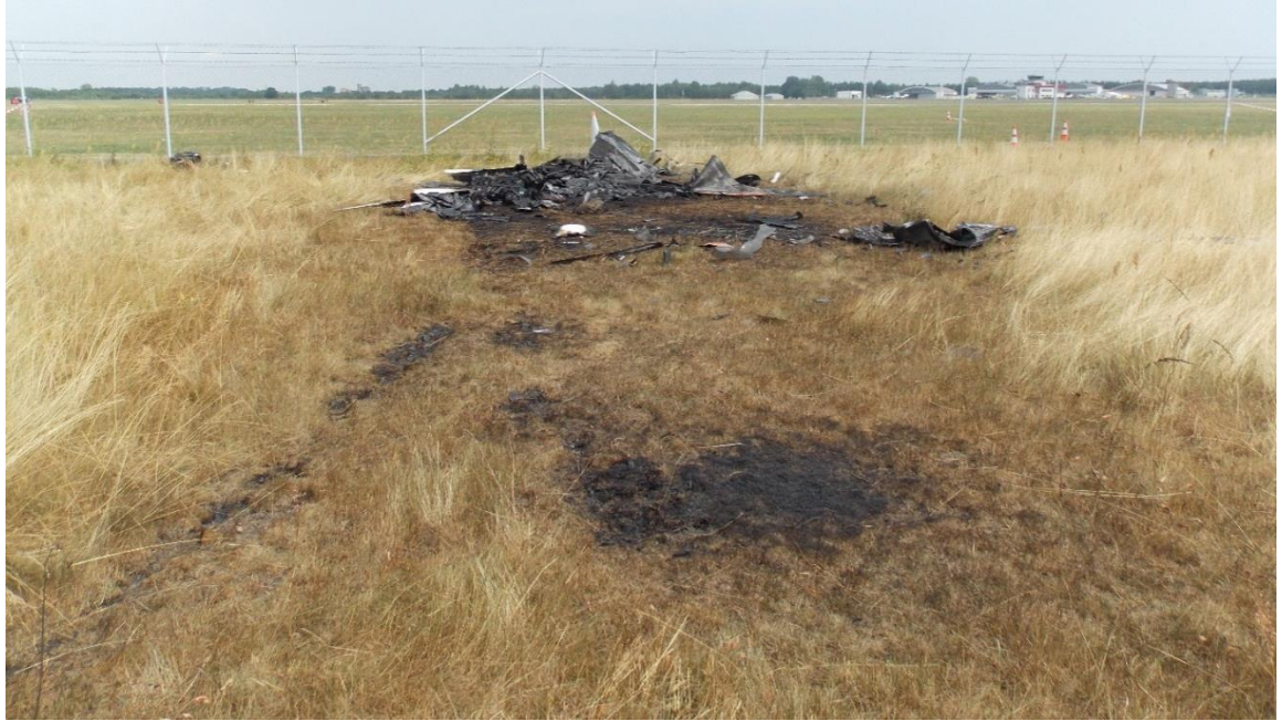
Rys. 11. Widok na miejsce zdarzenia. Widoczny spalony wrak samolotu oraz wypalona trawa wskazująca kierunek, w jakim rozlało się paliwo ze zbiorników po zderzeniu się samolotu z ziemią [źródło: PKBWL]
