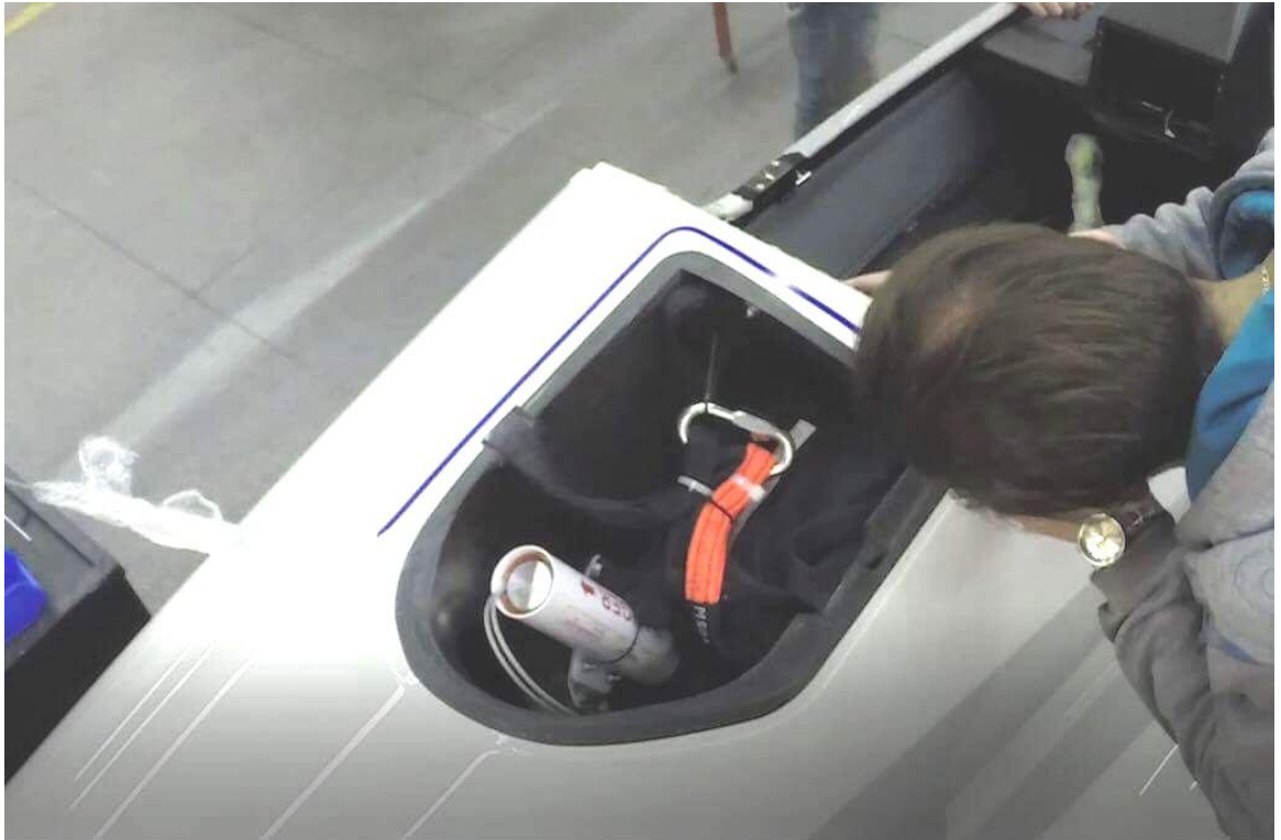
Rys. 9. Spadochronowy system ratunkowy BRS zamontowany na samolocie Tarragon [źródło: SIA Pelegrin ]
