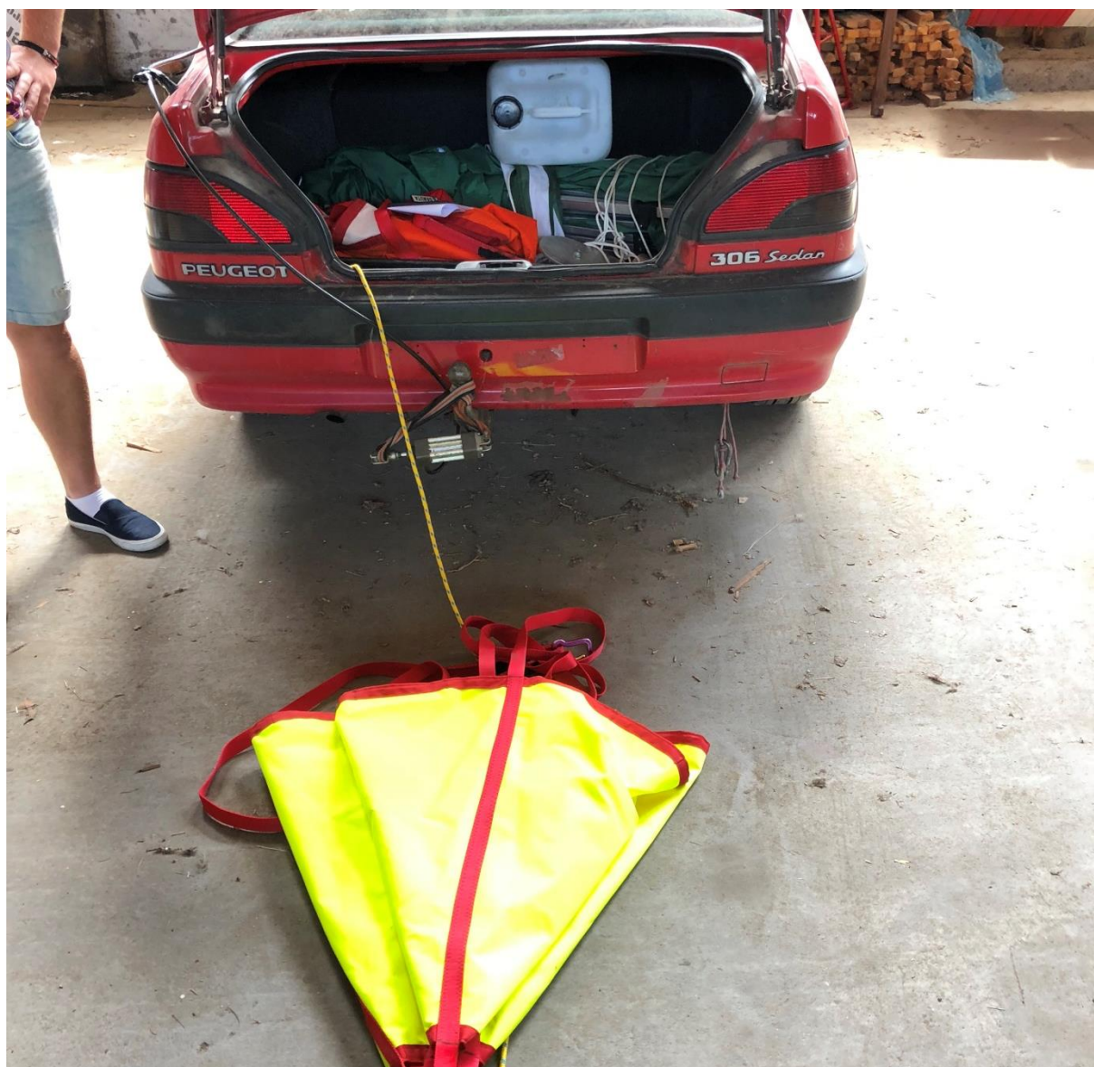
Rys. nr 2. Wyciągarka samochodowa do holowania paralotni.
