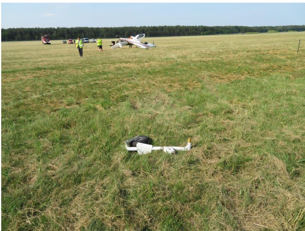
Rys. 2. Urwana goleń przedniego podwozia [źródło: PKBWL]
