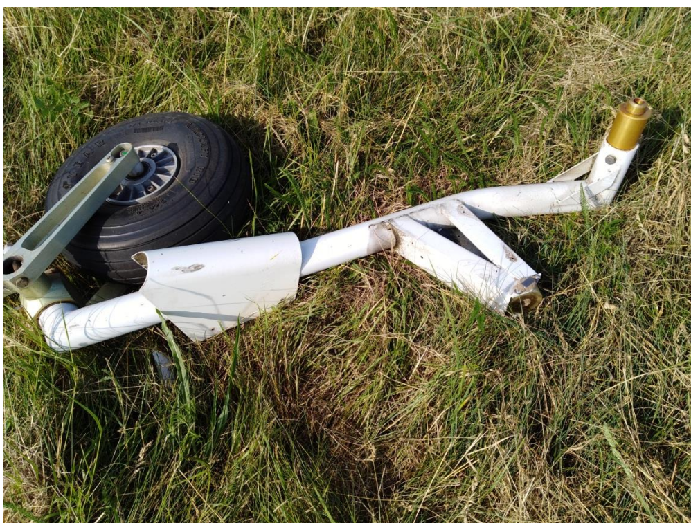
Rys. 6. Urwane przednie podwozie [źródło: PKBWL]
