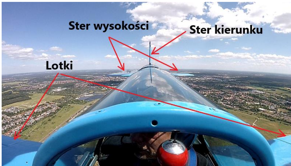
Rys. 6. Obraz z kamery na wiatrochronie – dobrze widoczne powierzchnie sterowe [źródło: właściciel samolotu – kadr z filmu video]
