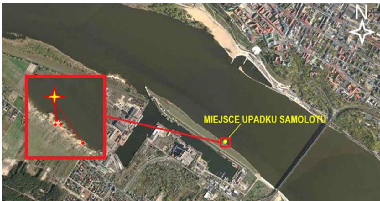
Rys. 2. Miejsce upadku samolotu i orientacyjny rozrzut szczątków (czerwona ramka) [źródło: PKBWL]
