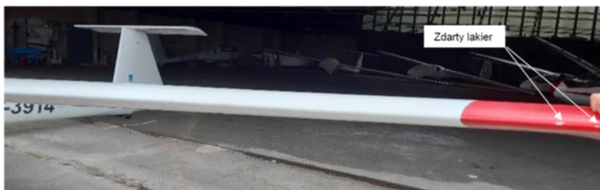
Rys. 10. Końcówka lewego zewnętrznego skrzydła szybowca SP-3914. Na krawędzi natarcia widoczne są ślady zderzenia [źródło: PKBWL]
