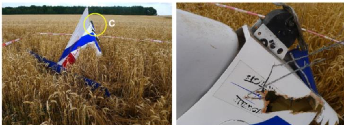
Rys. 13. Usterzenie szybowca SP-3652. Po prawej szczegół C uszkodzonego pokrycia z zakleszczonymi linkami sterowania kierunkowego
