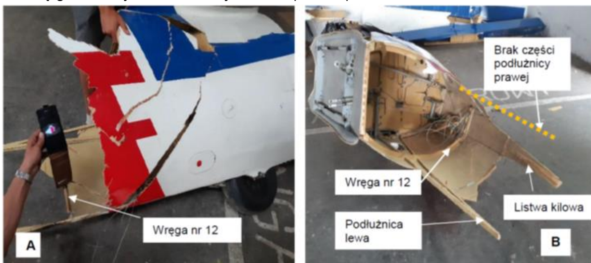
Rys. 12A. i 12B. Fragment kadłuba za kabiną pilota zniszczonego szybowca SP-3652:
