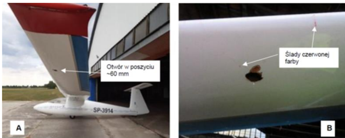
Rys. 9A. i 9B. Uszkodzenie lewego zewnętrznego skrzydła szybowca SP-3914 [źródło: PKBWL]
