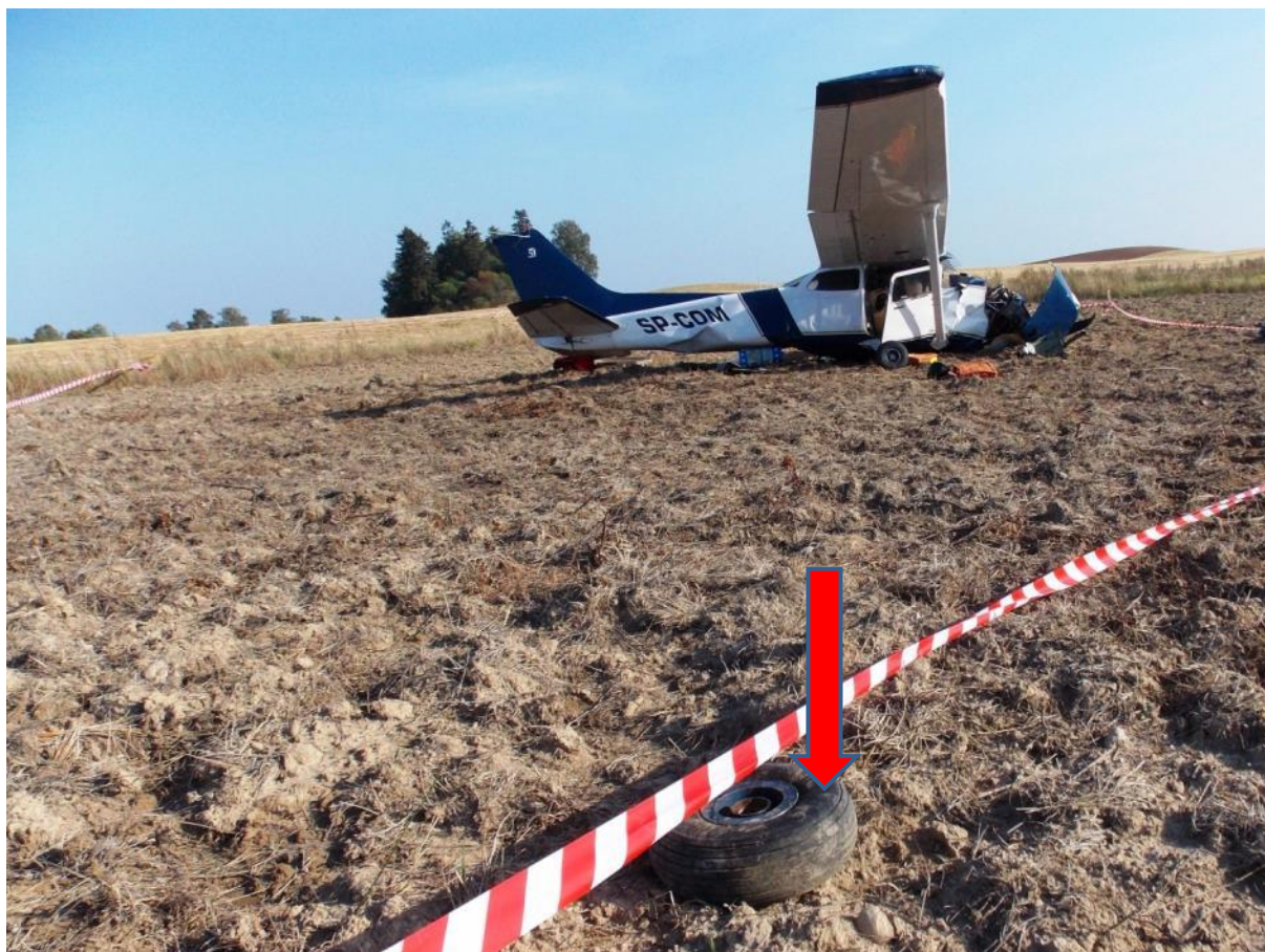
Rys. 3. Widok samolotu po zatrzymaniu, strzałką zaznaczono urwane koło przednie [źródło: PKBWL]
