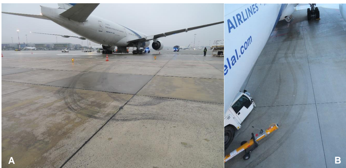
Rys. 10. Płyta lotniska EPWA: A – ślady opon prawego wózka podwozia głównego; B – ślady opon przedniej nogi podwozia
