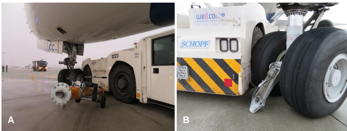
Rys. 9. Miejsce zdarzenia: A – widok ogólny pokazujący wzajemne położenie samolotu, dyszla i holownika po zdarzeniu; B – kolizja przedniej nogi samolotu z ciągnikiem
