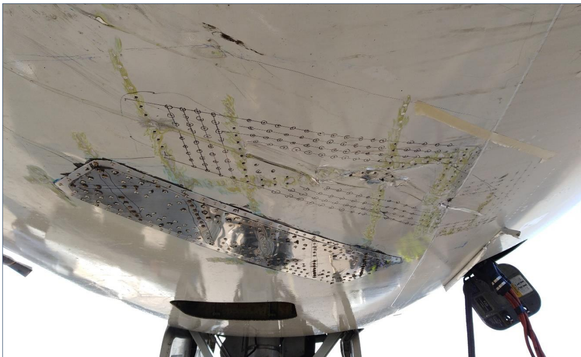
Rys. 3. B777-258 4X-ECC podczas naprawy na lotnisku EPWA – widok uszkodzeń
