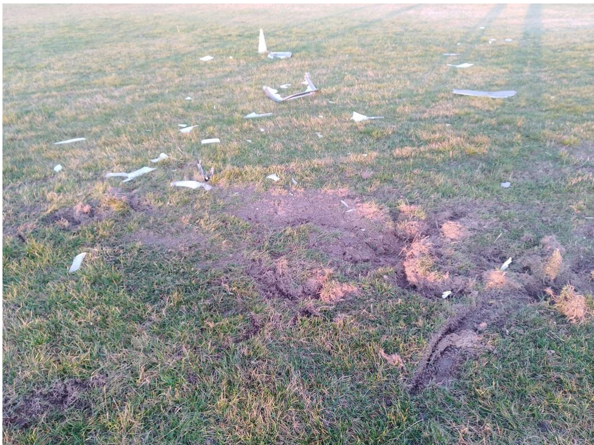
Rys. 7. Ślad po uderzeniu kadłuba wiatrakowca w ziemię [źródło: PKBWL]
