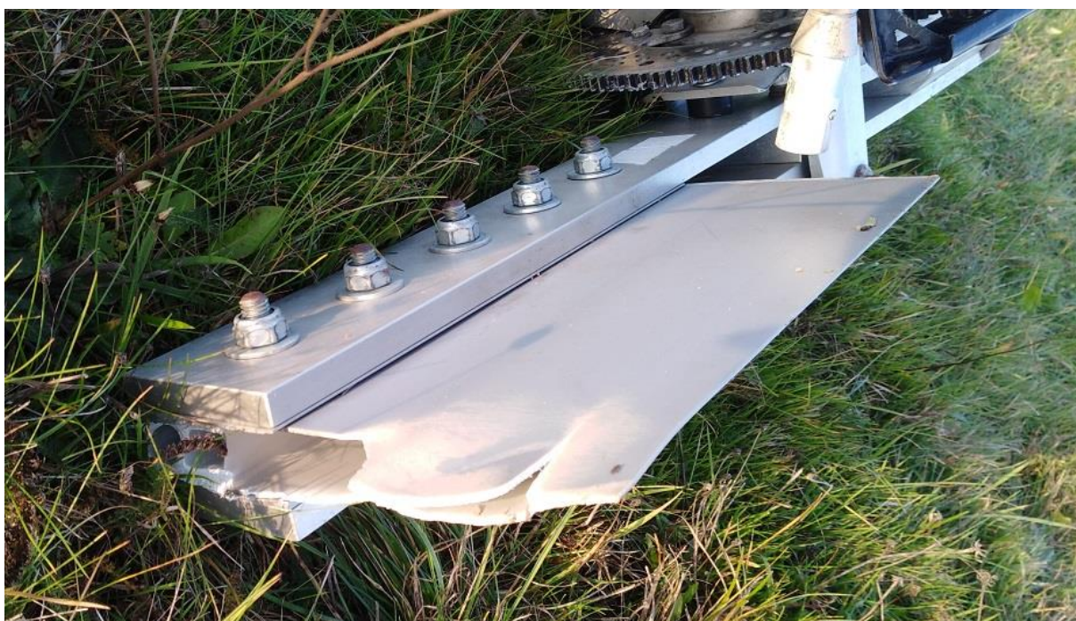
Rys. 12. Widok łącznika łopat wirnika nośnego od strony drugiej łopaty, zniszczonej na skutek wypadku [źródło: PKBWL]
