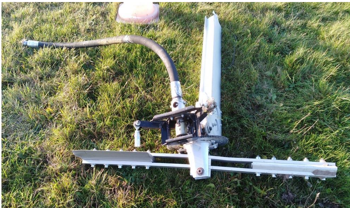
Rys. 9. Oddzielony od wraku maszt wirnika nośnego wiatrakowca [źródło: PKBWL]
