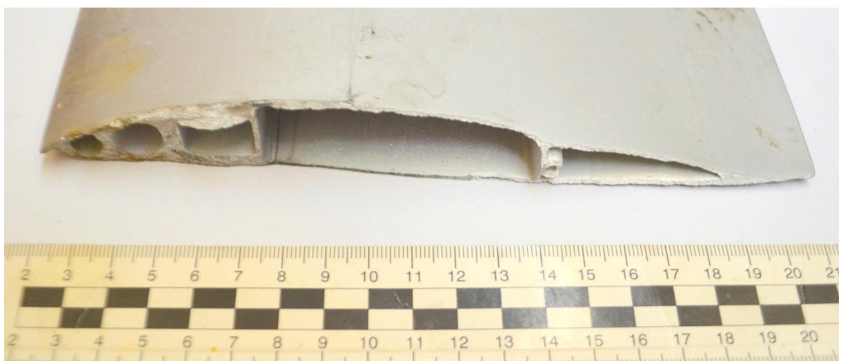
Rys. 14. Łopata wiatrakowca ZEN 1 przekazana do badań (miejsce przełamania) [źródło: Politechnika Śląska]
