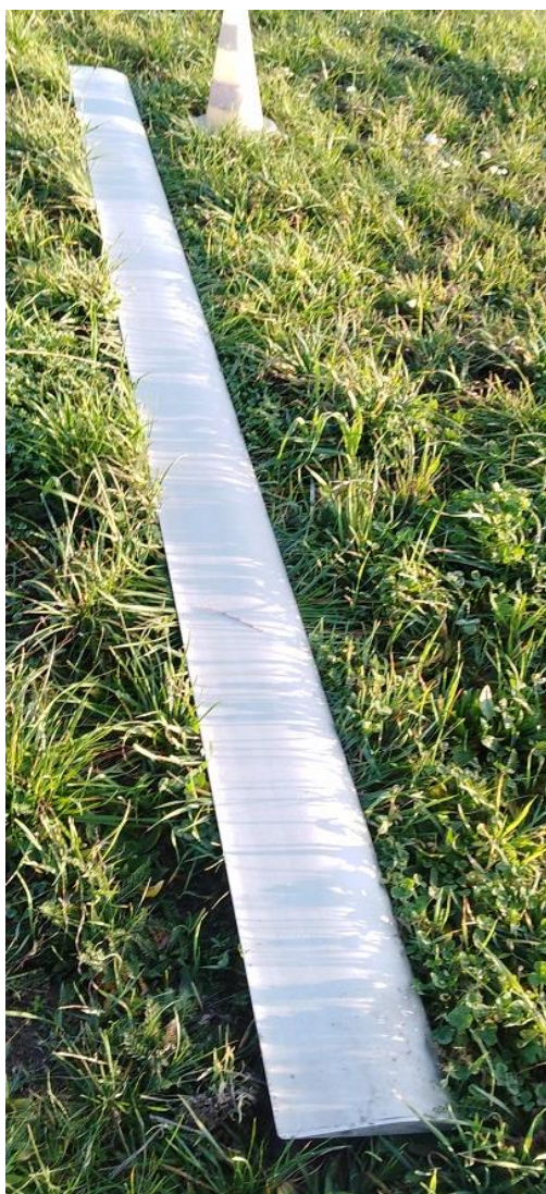
Rys. 5. Po lewej: łopata wirnika nośnego oderwana podczas lotu wiatrakowca; po prawej: łącznik łopat przy głowicy wirnika nośnego wiatrakowca – miejsce oderwania pierwszej łopaty [źródło: PKBWL]
