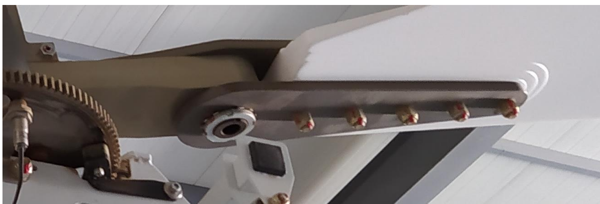
Rys. 30. Przykład łącznika łopat wirnika wiatrakowca z zastosowaniem kontrolowanego odsztywnienia łącznika poprzez zmianę jego szerokości [źródło: PKBWL]
