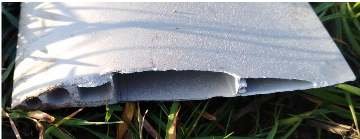
Rys. 4. Przełom łopaty wirnika nośnego wiatrakowca, która jako pierwsza uległa oderwaniu od łącznika [źródło: PKBWL]
