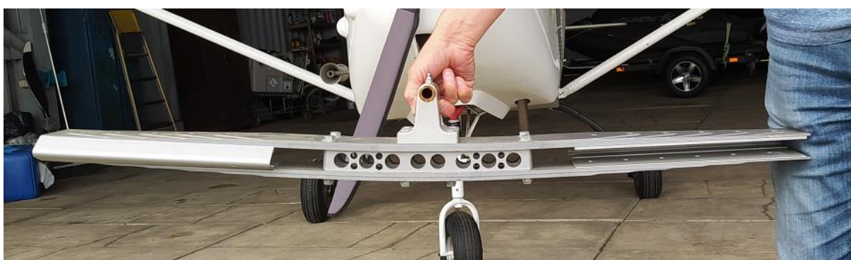
Rys. 31. Przykład łącznika łopat wirnika wiatrakowca z zastosowaniem wzniosu zmniejszającego moment gnący działający na pracujące łopaty [źródło: PKBWL]
