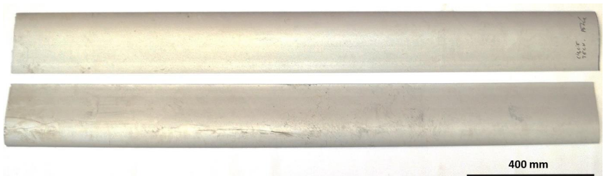
Rys. 13. Łopata wiatrakowca ZEN 1 przekazana do badań [źródło: Politechnika Śląska]
