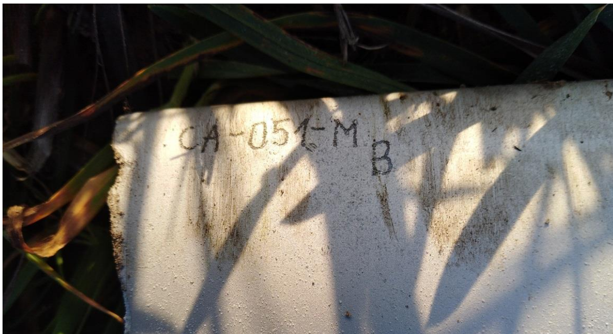
Rys. 6. Oznaczenie ujawnione na oderwanej łopacie wirnika nośnego na miejscu wypadku [źródło: PKBWL]
