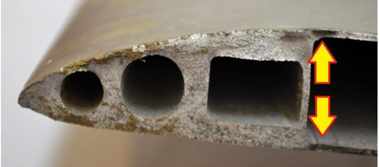
Rys. 15. Powierzchnia pęknięcia łopaty wiatrakowca ZEN 1. Miejsca, które wytypowano do badań za pomocą elektronowego mikroskopu skaningowego [źródło: Politechnika Śląska]
