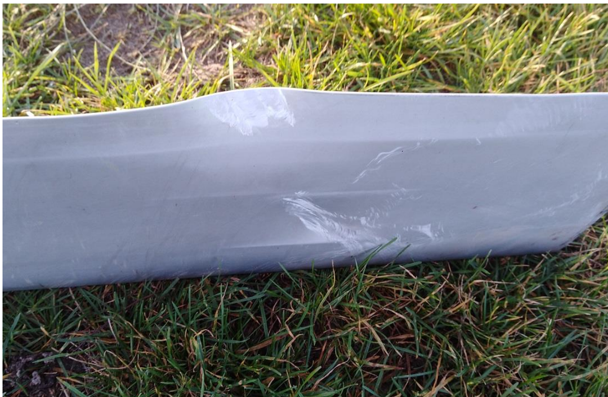
Rys. 11. Łopata zniszczona w następstwie wypadku [źródło: PKBWL]
