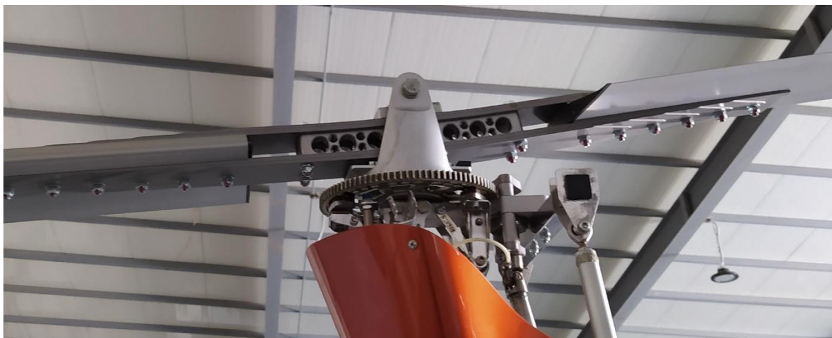
Rys. 32. Przykład łącznika łopat wirnika wiatrakowca z zastosowaniem wzniosu zmniejszającego moment gnący działający na pracujące łopaty [źródło: PKBWL]
