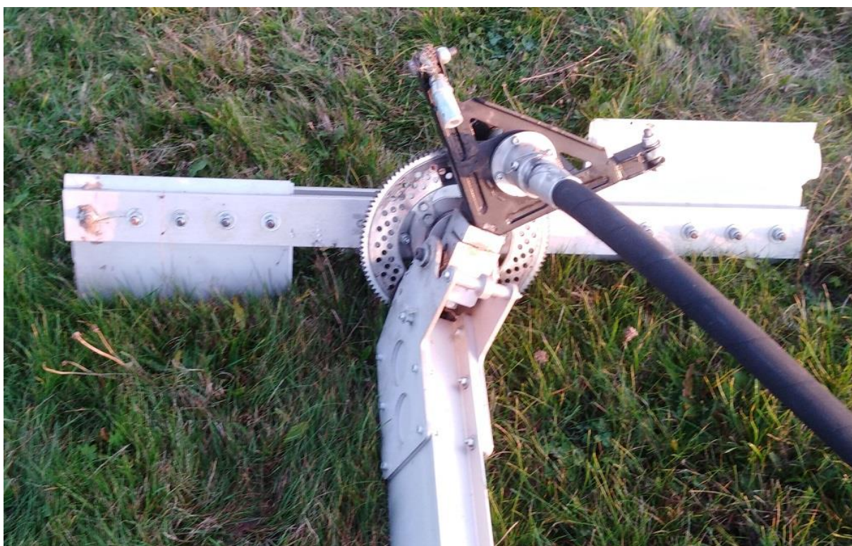
Rys. 10. Oddzielony od wraku maszt wirnika nośnego wiatrakowca – widok na dolną część głowicy. Po lewej stronie fragment łopaty oderwanej w pierwszej kolejności (samoczynnie), po prawej stronie fragment drugiej łopaty, zniszczonej na skutek wypadku [źródło: PKBWL]
