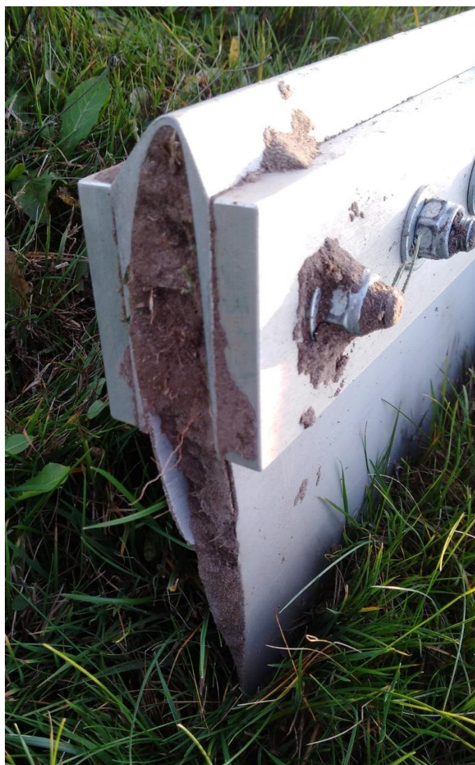
Rys. 5. Po lewej: łopata wirnika nośnego oderwana podczas lotu wiatrakowca; po prawej: łącznik łopat przy głowicy wirnika nośnego wiatrakowca – miejsce oderwania pierwszej łopaty [źródło: PKBWL]
