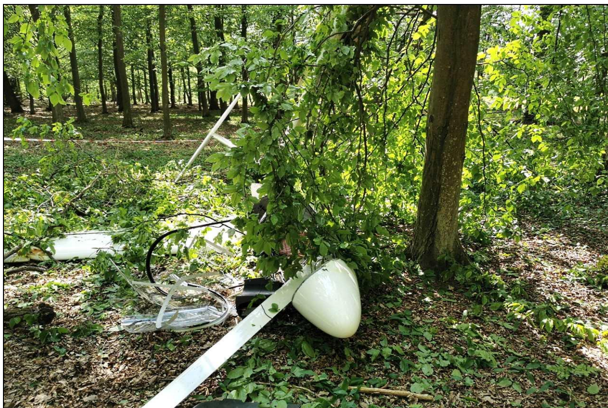
14 – Kadłub od przodu, na pierwszym planie widoczna oderwana lewa lotka.
