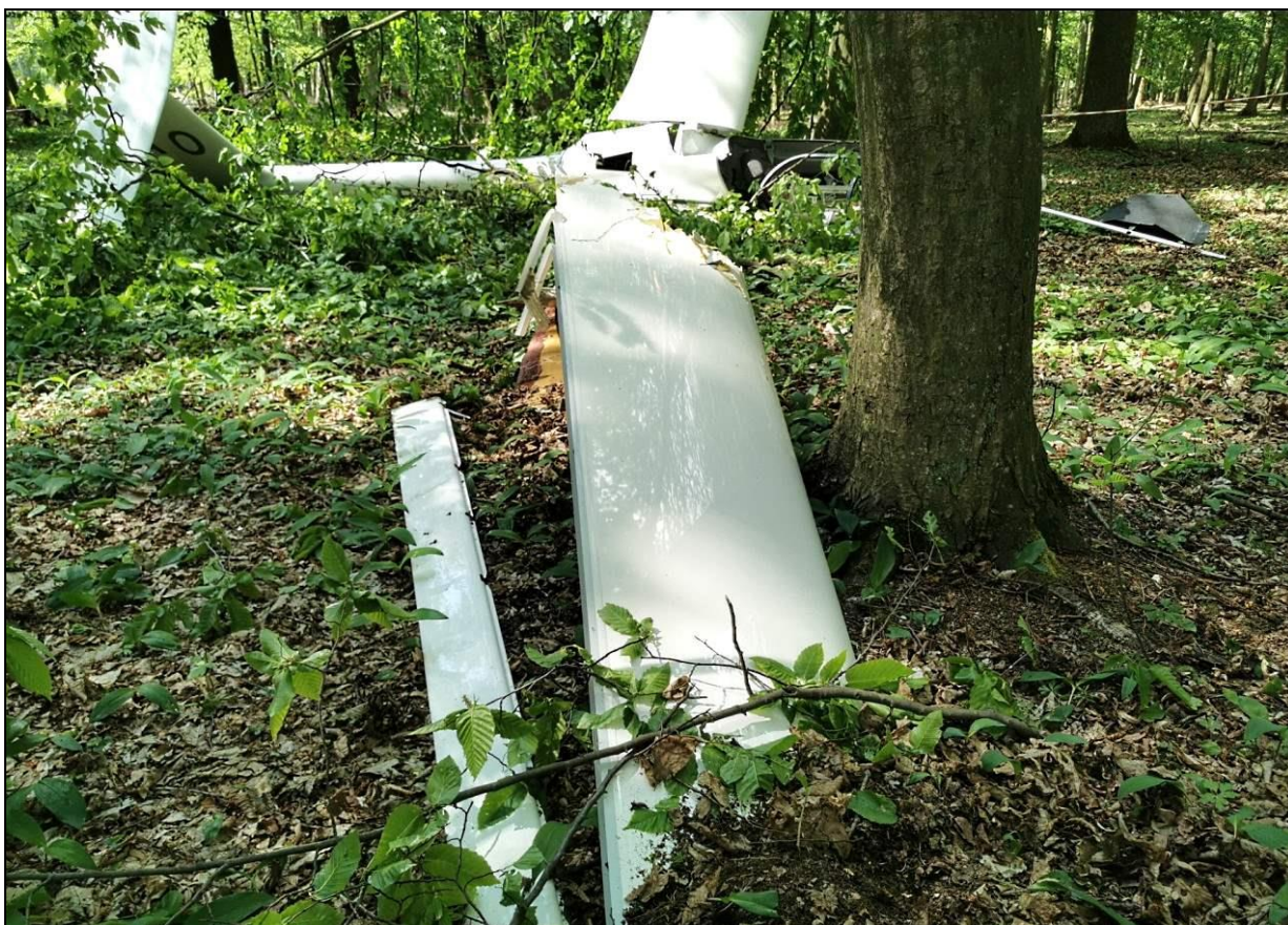
13 – Kadłub, skrzydła i usterzenie, widoczna oderwana prawa lotka.
