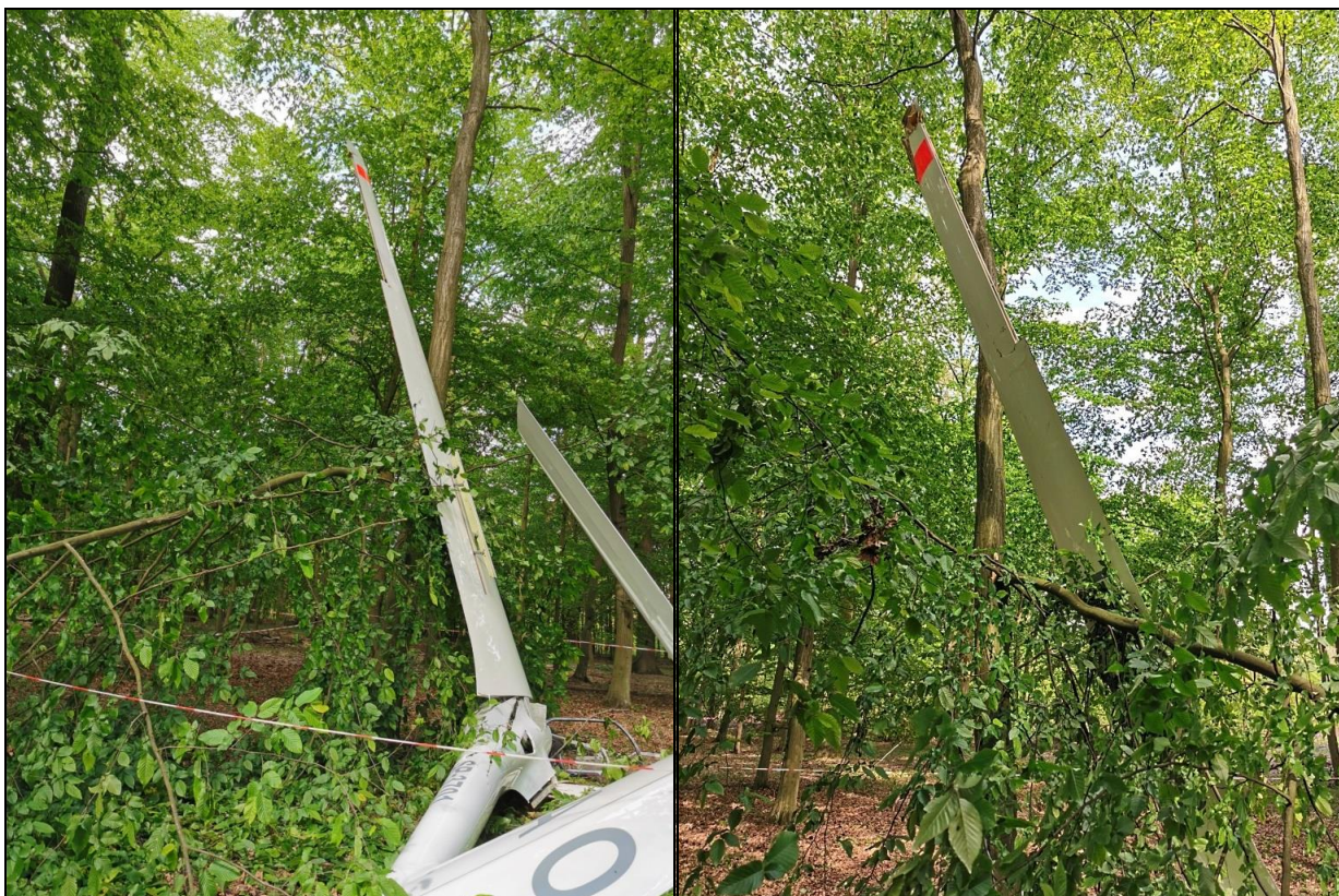
8, 9 – Ogólny widok rozbitego szybowca. Na fot.8 zwraca uwagę widoczne odkształcenie kadłuba za skrzydłami, wskazujące na jego złamanie boczne.
