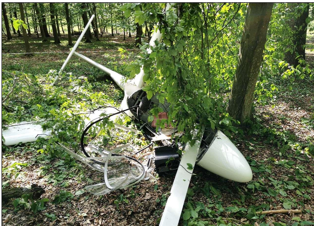
15 – Kadłub od przodu, widoczna zniszczona osłona kabiny, wyrwana tablica przyrządów i oderwana lewa lotka.
