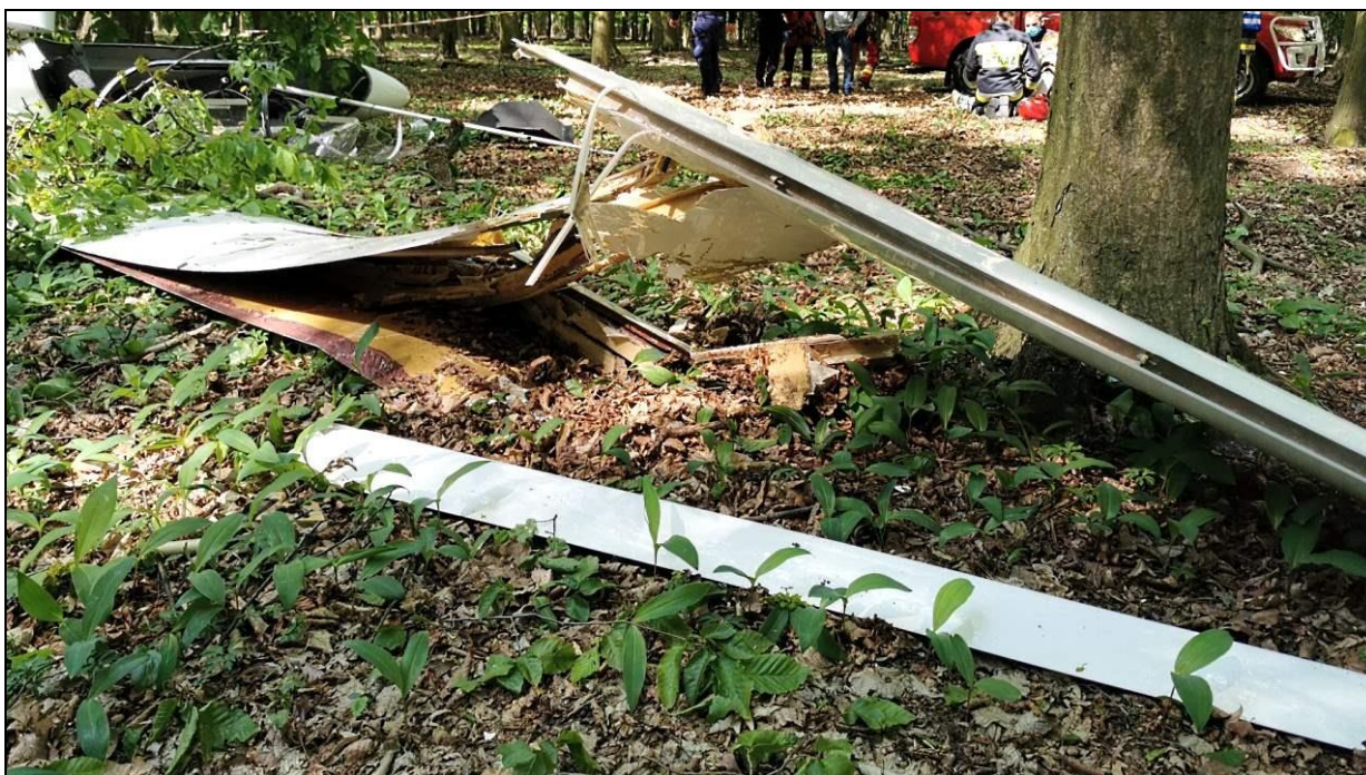
21 – Zbliżenie fragmentu zniszczonego prawego skrzydła, na pierwszym planie oderwana prawa lotka.
