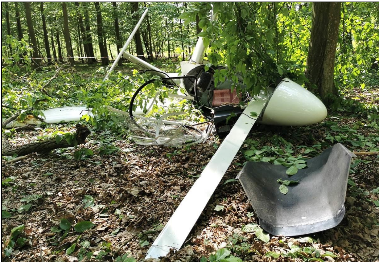
16 – Kadłub od przodu, widoczna zniszczona osłona kabiny, wyrwana tablica przyrządów, oderwana lewa lotka i osłona tablicy przyrządów.
