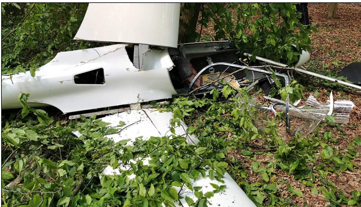
19 – Kabina i środkowa część kadłuba z zamocowaniami skrzydeł. Zwraca uwagę złamanie dźwigara prawego skrzydła w rejonie żebra nasadowego i zniszczenia kadłuba za kabiną.
