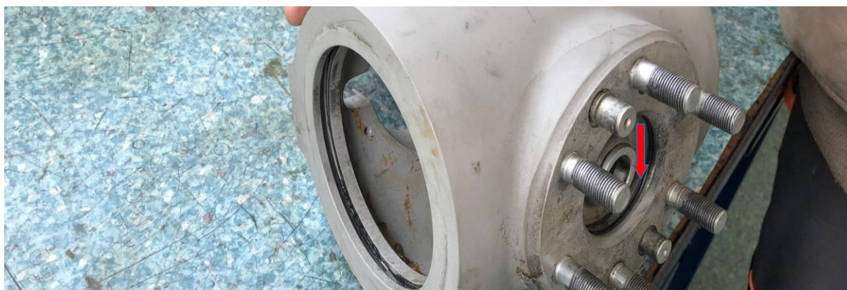
Rys. 2. Widok oringu uszczelniającego połączenie piasty z wałem korbowym [źródło: Franklin]
