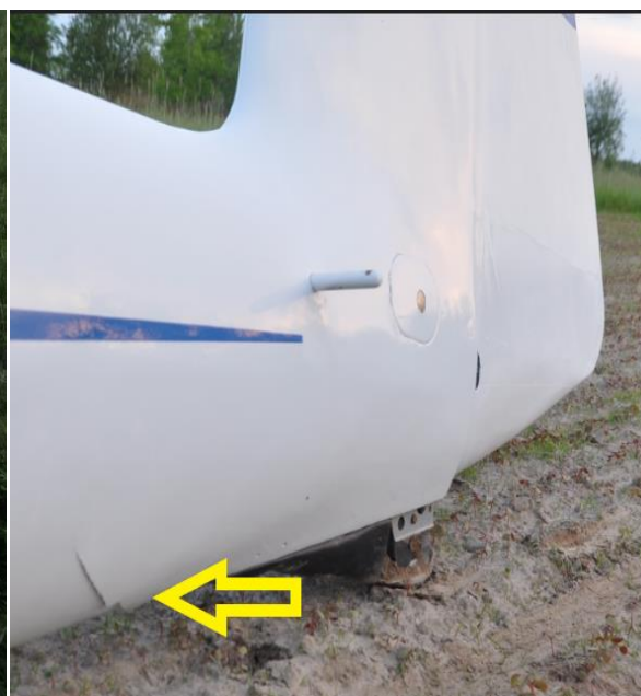
Rys. 3. Pęknięcie poszycia kadłuba w części ogonowej [źródło: użytkownik]
