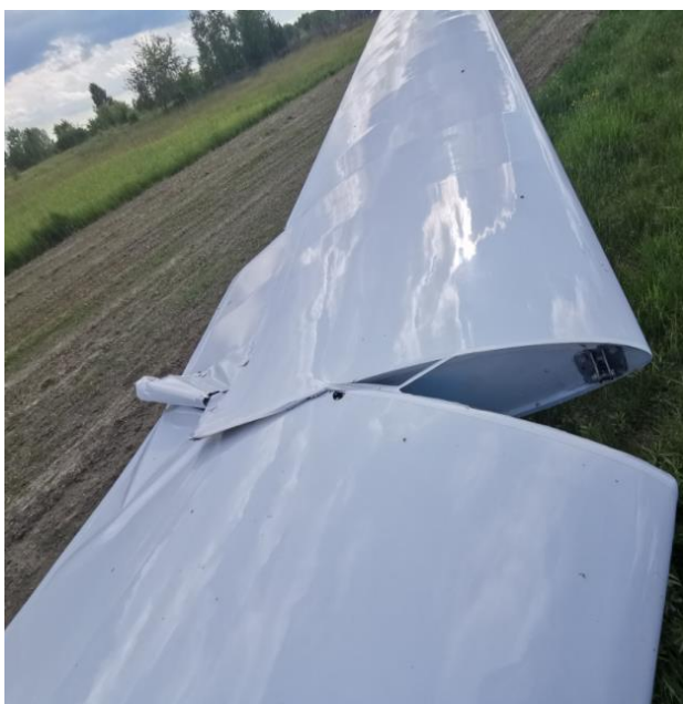
Rys. 2. Uszkodzony centropłat i wyłamana końcówka lewego skrzydła [źródło: użytkownik]
