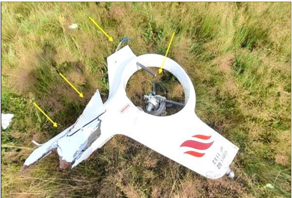
Rys. 7. Odcięta tylna część belki ogonowej z fenestronem [źródło: ACSL LAW]
