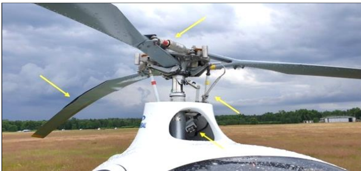
Rys. 4. Uszkodzenia śmigłowca SP-NCA – głowica wirnika nośnego [źródło: ACSL LAW]
