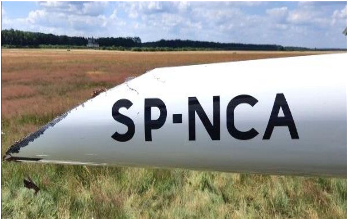
Rys. 6. Odcięcie belki ogonowej śmigłowca [źródło: ACSL LAW]
