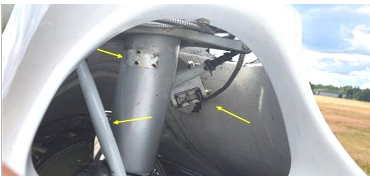
Rys. 5. Uszkodzenia śmigłowca SP-NCA – piasta wirnika nośnego [źródło: ACSL LAW]
