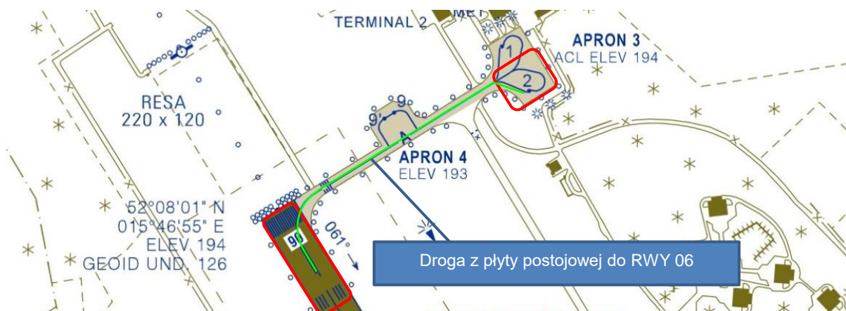
Rys. 6. Droga samolotu LOT7004 z płaszczyzny postojowej 3 do początku RWY 06 wynosi około 530 m. [źródło: AIP Polska AD2 EPZG 1-1-1]
