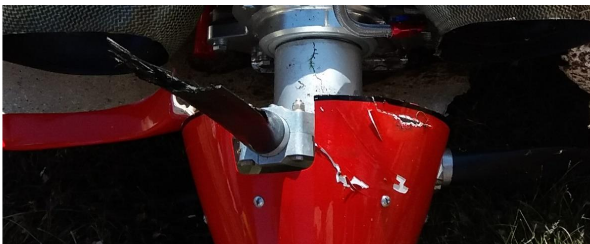
Rys. 9. Widok na jedną z łopat śmigła. Widoczny kąt zaklinowania łopaty [źródło: PKBWL]
