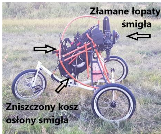
Rys. 1. Uszkodzenia wózka motoparalotni oraz zabudowanego zespołu napędowego [źródło: materiały udostępnione przez policję]
