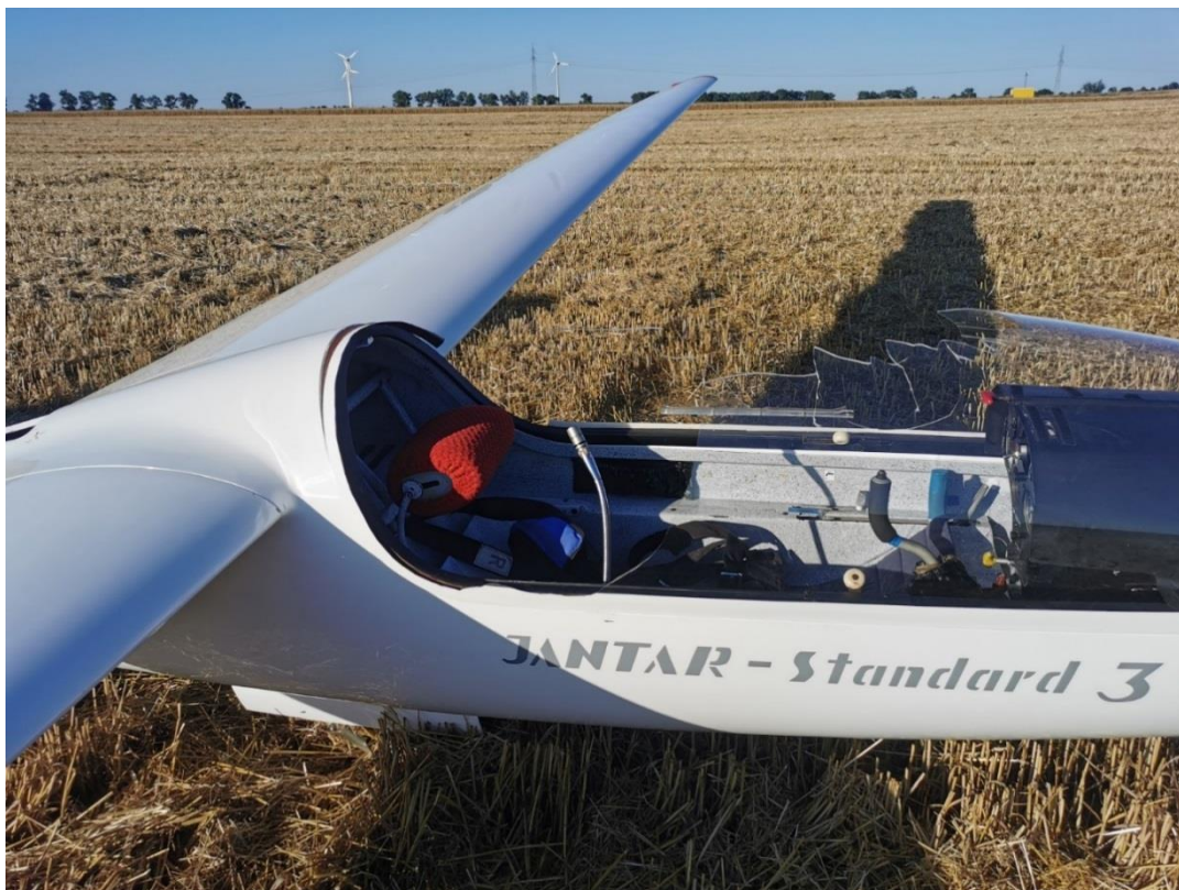
Rys. 2. Szybowiec SZD-48-3 Jantar Std 3, po lądowaniu w terenie przygodnym – widoczne uszkodzenia i ubytek osłony kabiny [źródło: PKBWL]
