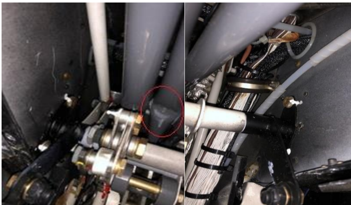
Rys. 24. Widoczne uszkodzenia popychaczy powstały na skutek odkształcenia kadłuba przy zderzeniu
