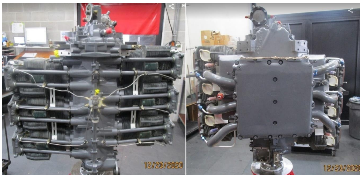
Rys. 19. Silnik na stanowisku, przygotowany do demontażu
