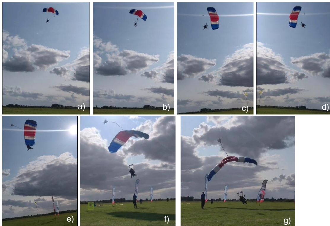
Rys. 5 Zapis podejścia: sekwencja zdarzeń w czasie 5 sek. przed przyziemieniem [źródło: PKBWL]
