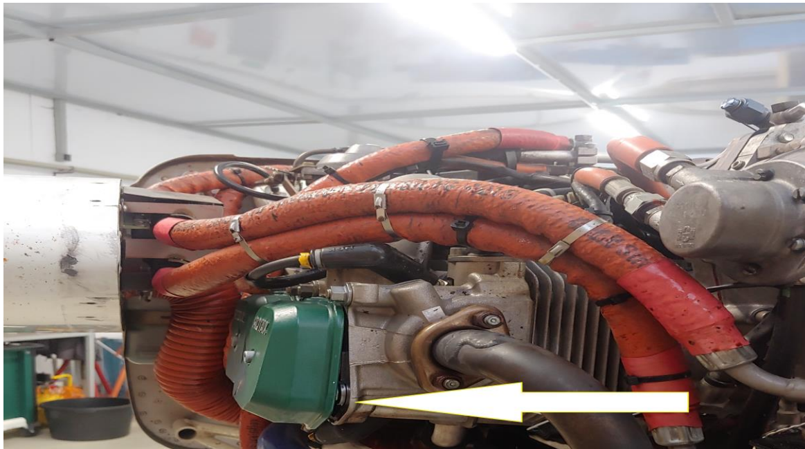
Rys.1. Widok miejsca odchylenia pokrywy zaworowej cylindra nr 1 po odkręceniu się śruby mocującej [źródło: użytkownik]
