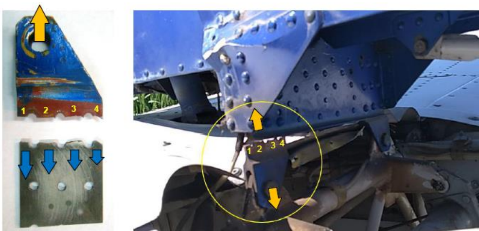
Figura 19. Carga principal sobre el herraje derecho. Fuente: investigación JST
