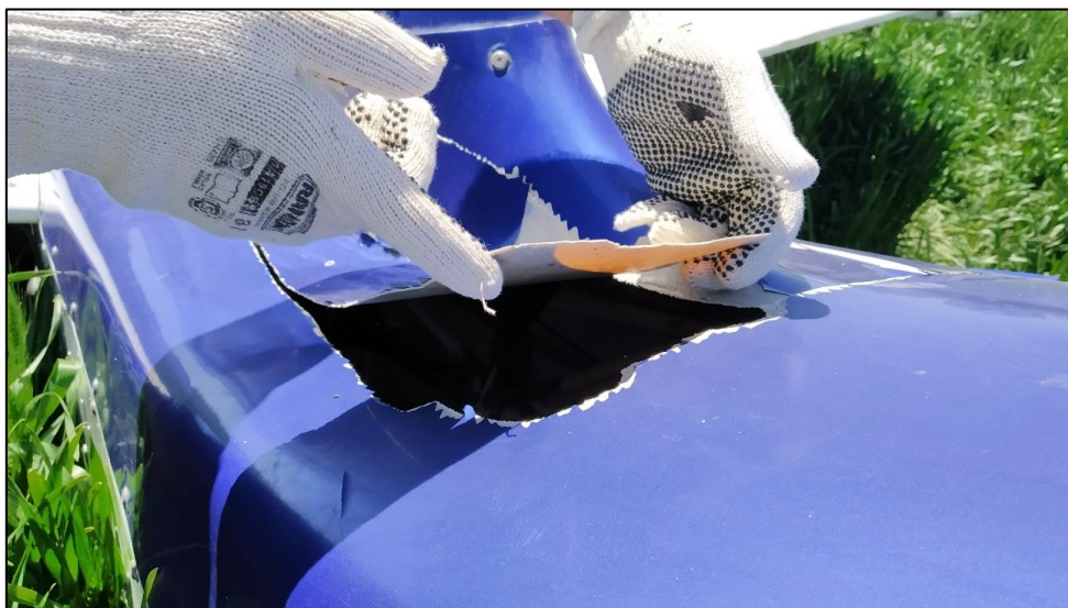
Figura 3. Daños en fuselaje. Fuente: investigación JST
