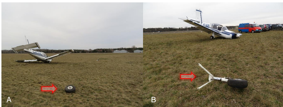
Rys. 3. Samolot PZL – Koliber 160A SP-GZB na miejscu zdarzenia: A – oderwane lewe koło podwozia głównego, B – oderwana goleń podwozia przedniego
