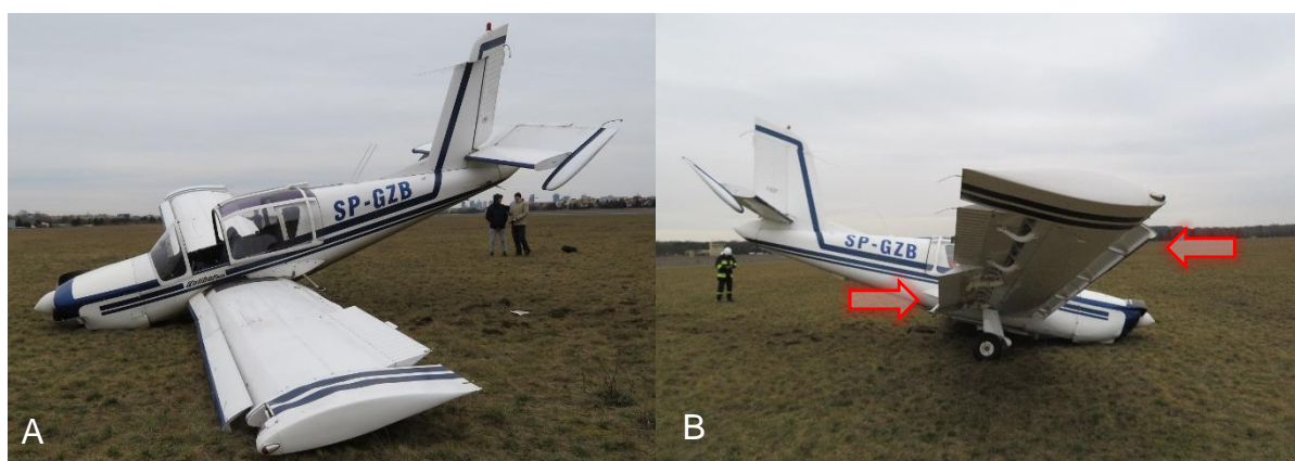
Rys. 2. Samolot PZL – Koliber 160A SP-GZB na miejscu zdarzenia: A – widok ogólny z lewej strony, B – widok z prawej strony (strzałkami pokazano wypuszczone kłapy oraz sloty)
