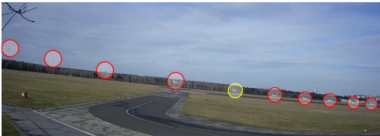
Rys. 4. Lądowanie samolotu PZL – Koliber 160A SP-GZB na lotnisku EPBC (zapis poklatkowy kamery monitoringu nr 15) – okręgiem koloru żółtego wyróżniono moment wyrównania
