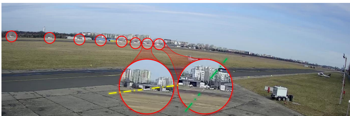
Rys. 5. Lądowanie samolotu PZL – Koliber 160A SP-GZB na lotnisku EPBC (zapis poklatkowy kamery monitoringu nr 16) – na powiększeniach 2 ostatnich kadrów linią koloru żółtego pokazano oś podłużną samolotu, linią koloru zielonego oś poprzeczną
