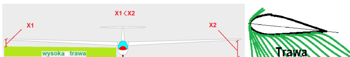
Rys. 6. Po lewej stronie pokazano jak zmienia się odległość skrzydła szybowca od powierzchni lotniska przy niewykoszonej trawie. Po prawej stronie pokazano jak trawa zawija się na krawędzi natarcia skrzydła [źródło: PKBWL]
