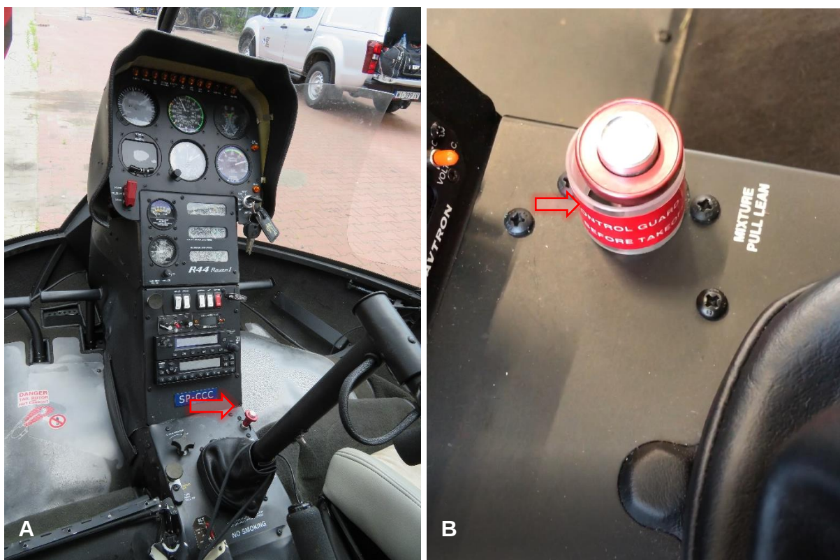
Rys. 6. Ciężno składu mieszanki paliwowo powietrznej: A – widok ogólny położenia ciężna w kabinie R44 SP-CCC; B – powiększenie wciśniętego ciężna z widocznym pierścieniem zabezpieczającym przed przypadkowym wyciągnięciem (zdjęcie wykonane na innym śmigłowcu)
