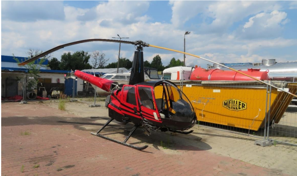
Rys. 2. Robinson R44, SP-CCC – wrak śmigłowca po wydobyciu z jeziora (widoczne liczne uszkodzenia konstrukcji m.in.: zdeformowana kabina z rozbitą osłoną i rozerwanym dolnym pokryciem)
