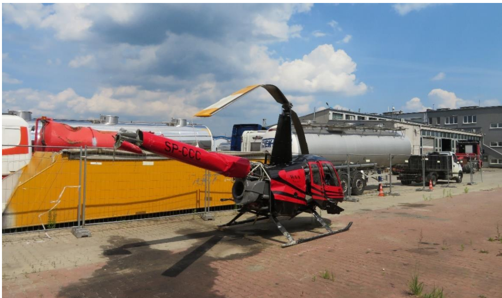
Rys. 3. Robinson R44, SP-CCC – wrak śmigłowca po wydobyciu z jeziora (widoczne liczne uszkodzenia konstrukcji m.in.: zdeformowany przedział silnika i belka ogonowa, urwane śmigło ogonowe wraz z przekładnią oraz statecznik pionowy, poziomy, osłona śmigła ogonowego i płoza ogonowa)
