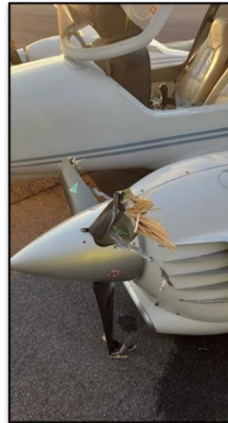
Rys. 4 i 5. Samolot SP-TRL ze zniszczonymi łopatami śmigieł prawego i lewego silnika. [źródło: PKBWL]
