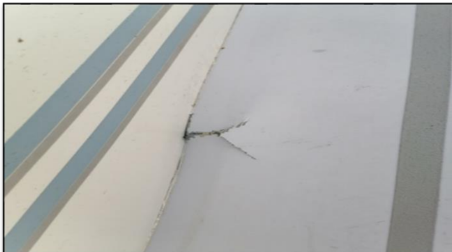
Rys. 6. Uszkodzenie płotowca na połączeniu skrzydła i kadłuba [źródło: PKBWL]
