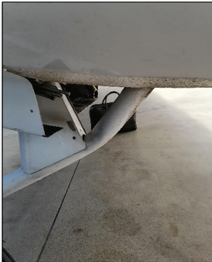
Rys. 2. Uszkodzenia podwozia przedniego samolotu [Źródło PKBWL].
