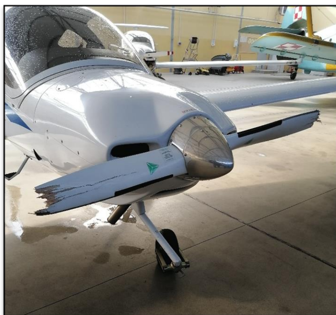
Rys. 1. Uszkodzenia śmigła oraz podwozia przedniego samolotu [Źródło PKBWL]
