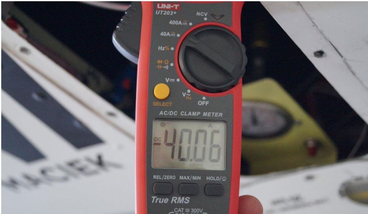
Rys. 5. Wynik pomiaru wartości prądu płynącego przez przekaźniki elektryczne układu wypuszczenia i chowania podwozia sfotografowany podczas próby [źródło: PKBWL]
