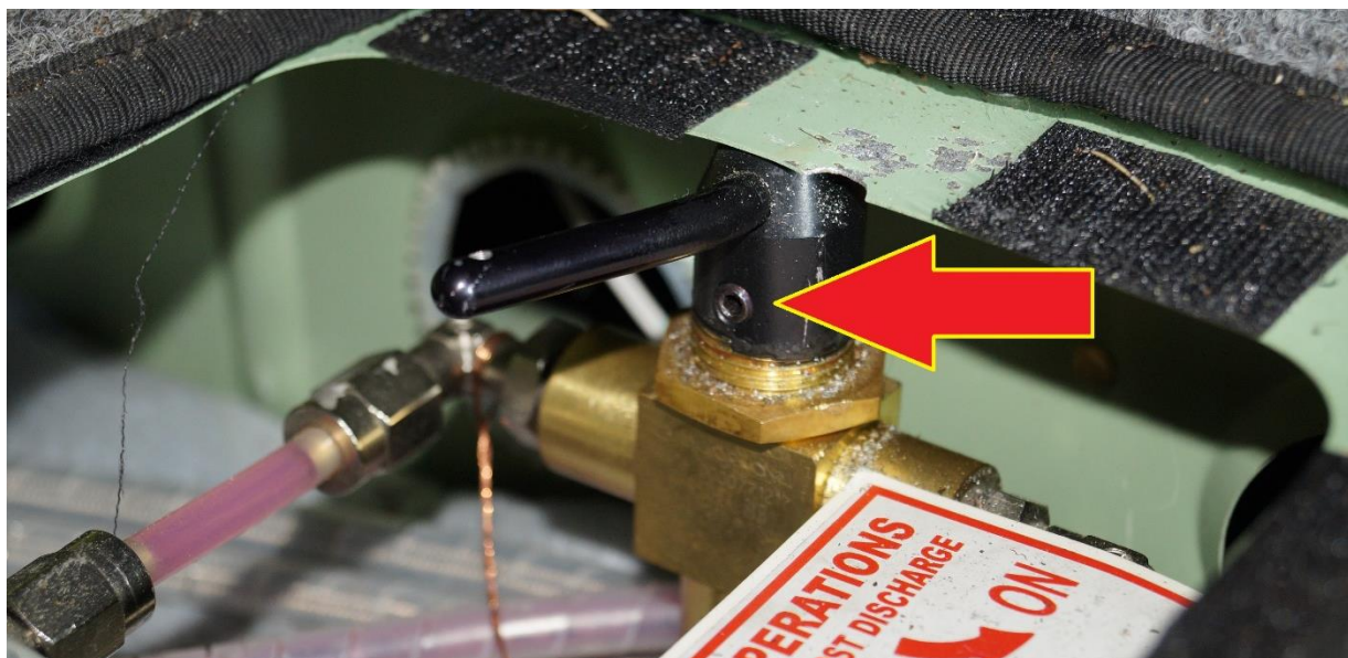
Rys. 11. Połączenie dźwigni z prawym zaworem układu awaryjnego wypuszczania podwozia. Strzałką oznaczono śrubę robaczkową, przeciwdziałającą swobodnemu obrotowi dźwigni na wałku zaworu [źródło: PKBWL]
