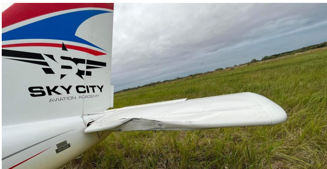
Rys. 2 Uszkodzenie lewego statecznika płytowego [źródło: Policja]
