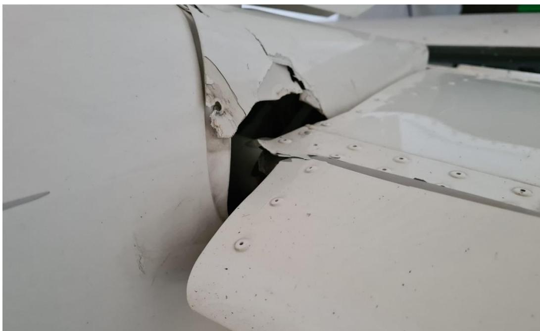
Rys. 3. Uszkodzenia tylnej części kadłuba [źródło: Policja]
